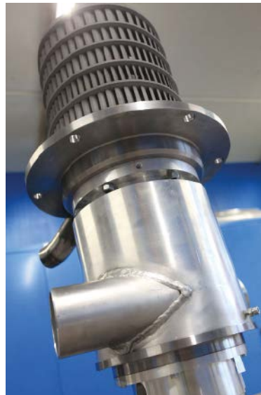
Der integrierte dynamische Sichter mit einer Umfangsgeschwindigkeit bis 190 m/s bestimmt die Produktfeinheit.
