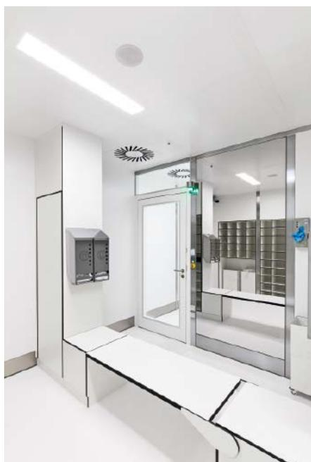
**Abb. 4:** Personenschleusen dienen als Zugang zum Reinraum.
