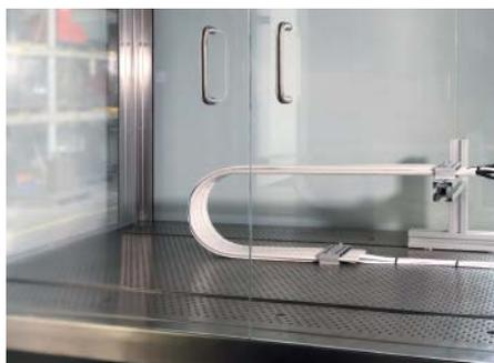
**Abb. 1:** Mithilfe einer Laminar Flow Box ist es möglich, genau dort Reinraumbedingungen zu schaffen, wo sie gerade benötigt werden.
