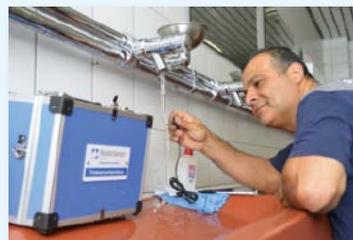
Legionellenprüfung wird jetzt relevant für alle möglichen Bereiche. Im Idealfall sollte an jeder Entnahmestelle alle 72 Stunden ein Wasseraustausch stattfinden.“
