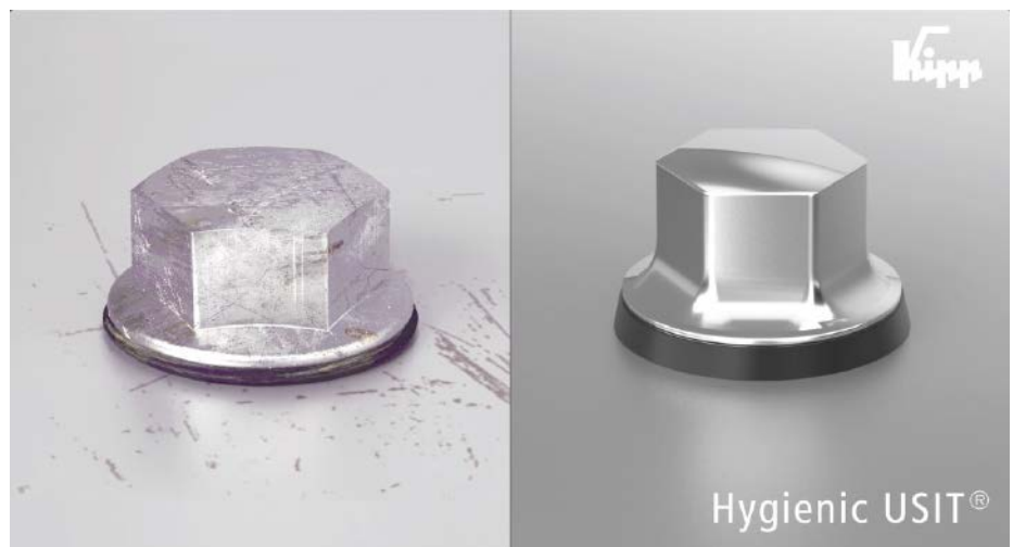
■ Abb. 4: Auch hier offensichtlich: Glattpolierte Oberflächen der Schrauben und Hutmuttern mit einer Rautiefe von weniger als 0,8 µm erhöhen die Reinigbarkeit (rechts).
