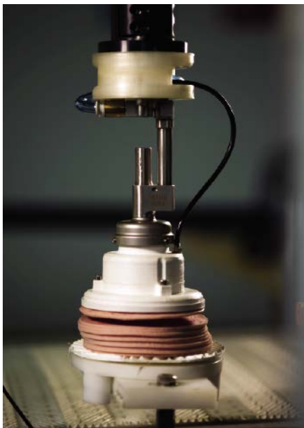
■ Abb. 2: Das Trennen von vorkommissionierter Scheibenware wurde lange als Hindernis zur Automatisierung eines Prozesses gesehen. Die neu entwickelte Saugglocke kann dieses Problem lösen.
