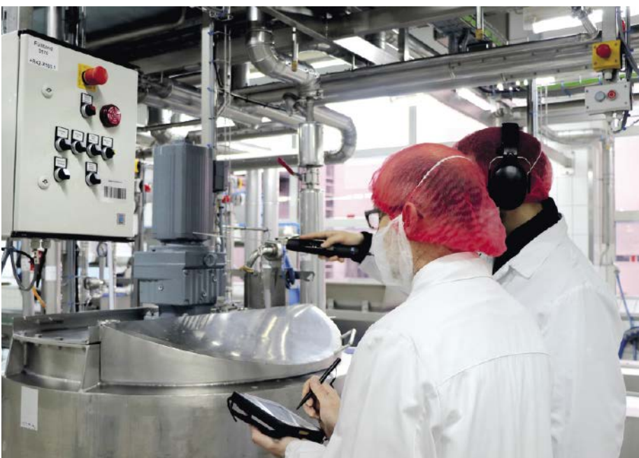
■ Abb. 3: Alle Ergebnisse des Kurzschecks werden für jeden einzelnen Motor detailliert mit dem Tablet festgehalten.
