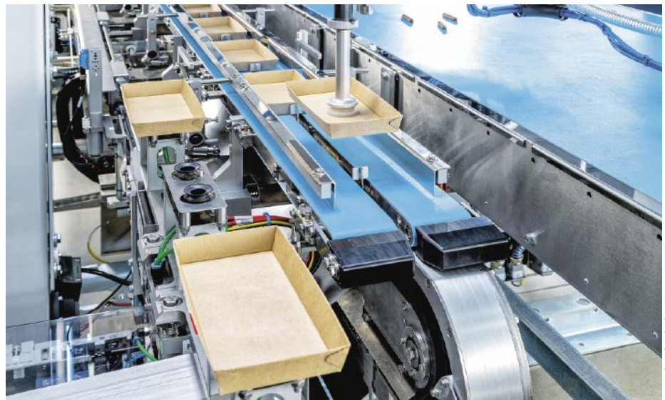
■ Abb. 2: In weniger als 30 Minuten wechselt die Schlauchbeutelmaschine zwischen verschiedenen Formaten. Auch papierbasierte Trays, U-Boards und Folien werden unterstützt.
