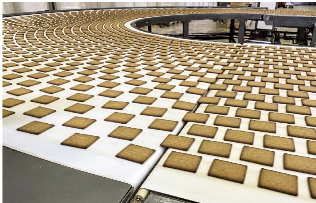
■ Abb. 2: 4.200 Kekse pro Minute müssen in der hochwertigen Qualitätssicherung auf viele Merkmale sehr präzise detektiert und in IO/NIO klassifiziert werden.
