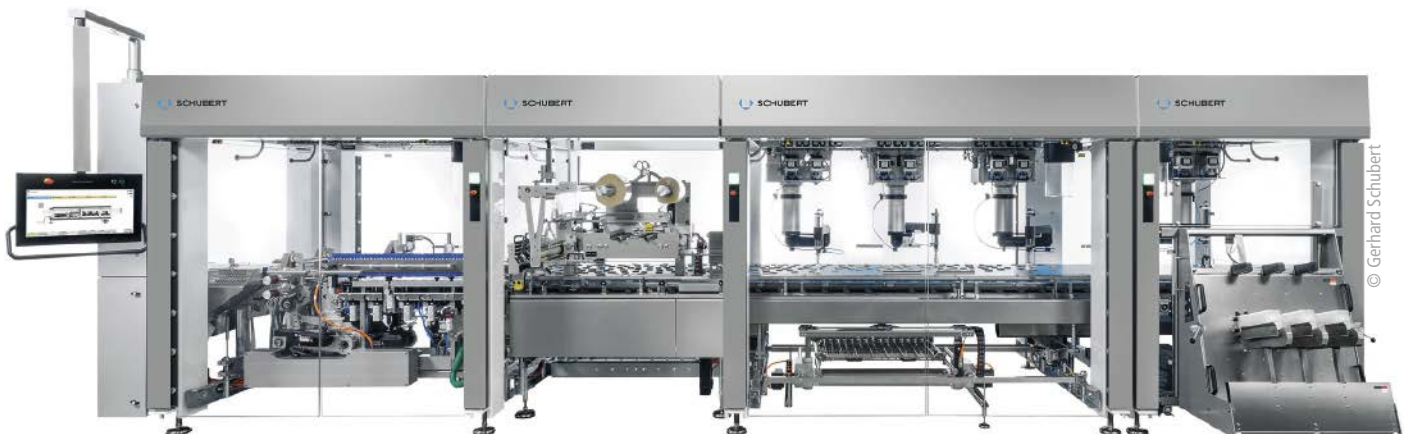
■ Abb. 1: Auf kleinem Raum vereint die Schlauchbeutelmaschine Entstapler, Pick-and-Place-Roboter, Qualitätskontrolle und das Flowmodul.
