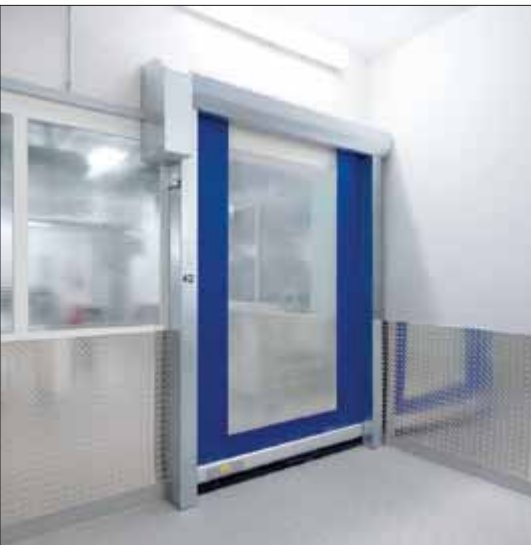
Abb. 3: Die Abdeckung der Rolltor Wickelwelle ist schräg ausgeführt, damit Flüssigkeiten ablaufen können und nichts auf den Fahrweg oder Lebensmittel tropft.
