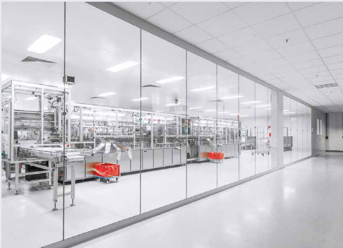
Reinraummontage: Ein Blick in die heutige vollautomatisierte Reinraummontage ISO-Klasse 7 am Standort Mühlthal, an der Papiermühle.
