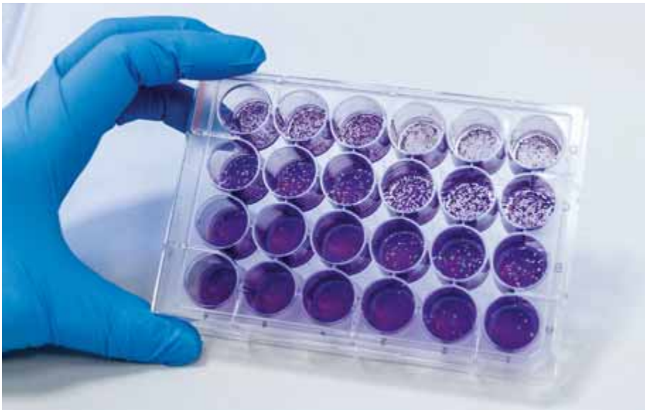
Abb. 1: Mit einem Virus-Aktivitätstest untersuchen die Fraunhofer-Wissenschaftler, ob mit Lüftungsanlagen gefilterte Luft noch infektiöse und damit übertragbare Viren enthält.
