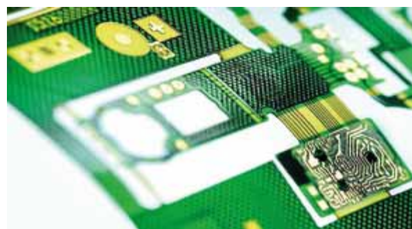
Abb. 3: Flexible Leiterplatte für den Einsatz in Hörgeräten
