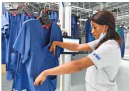
Abb. 1: An der Qualitätsstelle erfolgt die Kontrolle auf Flecken und Defekte. Je nach Ergebnis wählt die Mitarbeitende per Touchscreen den nächsten Bearbeitungsschritt
