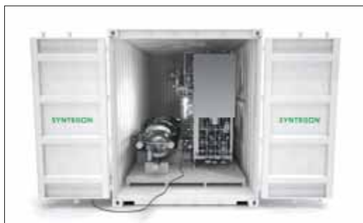
Abb. 1: Dank ihrer standardisierten modularen Bauweise kann Syntegon die Pharmatec SVP Essential in nur sechs Monaten als einsatzbereite Anlage liefern.
