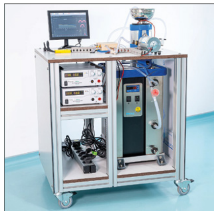
Abb. 3: Mobile Reaktoranlage für den Vor-Ort-Einsatz.
