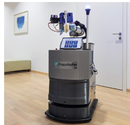
Abb. 2: Für den Regelbetrieb wird das Tablet am Roboter befestigt und dieser fährt selbstständig von einem zu reinigenden Objekt zum nächsten.
