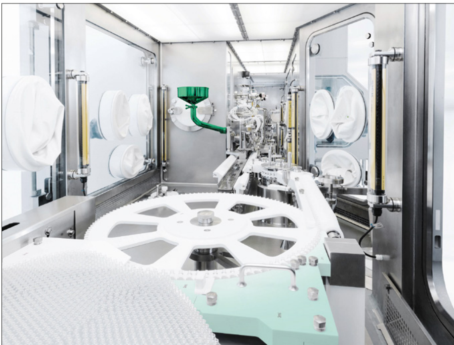
Abb. 2: Besonders bei neuen Linien sollten Dekontamination, Produktoxidation und die zulässige Restkonzentration von H_2O_2 bereits in der Design- und Engineeringphase berücksichtigt werden, um deren Auswirkungen auf die Zykluszeiten zu minimieren. © Syntegon
