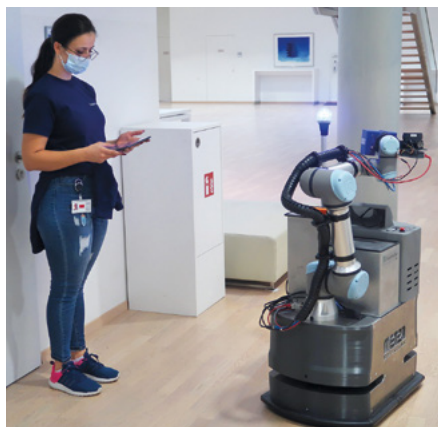
Abb. 1: Während der Praxistests konnten Reinigungskräfte den Roboter über ein Tablet einlernen.
