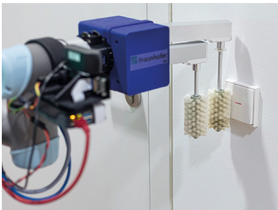
Abb. 3: Mithilfe seines flexiblen Reinigungswerkzeugs kann DeKonBot 2 unterschiedliche Oberflächen desinfizieren, neben Türklinken und -knäufen auch Aufzugknöpfe oder Lichtschalter.
