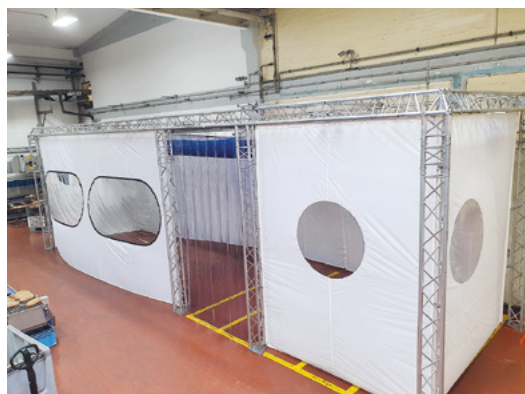
Abb. 1: Reinraumkabine ISO 9 mit Lamellenvorhang in einer Produktionshalle
