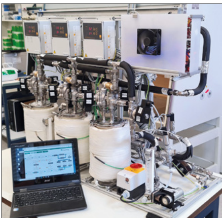
Abb. 2: Das Prinzip Virusgrill Apparat zur thermischen Inaktivierung Aerosolgetragener Viren.
