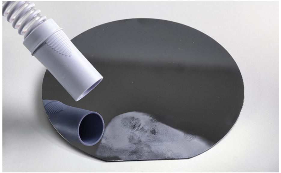
Abb. 10: Bedampfen der Oberfläche mit dem Gerät Confis
