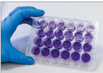
Abb. 4: Mit Virus-Infektionstests, z.B. einem Plaque- oder TCID50-Assay, untersuchen die Fraunhofer-Forschenden, ob die Luft nach der Inaktivierung noch infektiös und damit übertragbare Viren enthält.
