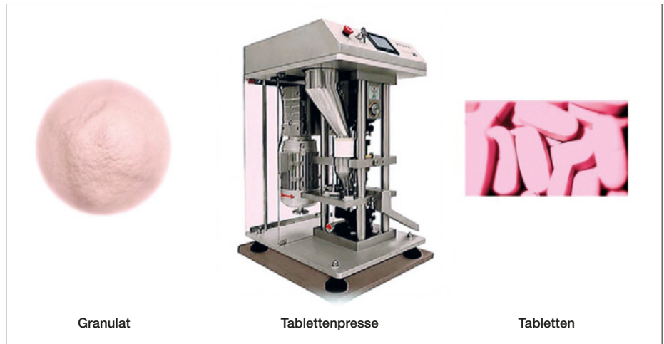
Abb. 2: Die meisten Tabletten enthalten Hilfsstoffe die der Verarbeitbarkeit dienen und dafür sorgen, dass das Pulver besser aus der Presse kommt. Unter Anwendung von Klebemitteln wird aus feinem Pulver ein grobkörniges Granulat, das sich leichter verpressen lässt. Farbstoffe schützen lichtempfindliche Wirkstoffe und helfen dem Patienten bei der Identifizierung des Arzneimittels. © AwKG
