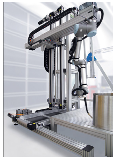
Abb. 3: Für ein robotergestütztes Handling- und Bearbeitungsportal kombinierte RK Rose+Krieger insgesamt vier Linearachsen vom Typ RK DuoLine Z 80 Protect, eine rollengeführte Linearachse RK MonoLine Z 120 und diverse Aluminiumprofile aus dem BLOCAN-Baukasten. © RK Rose+Krieger
