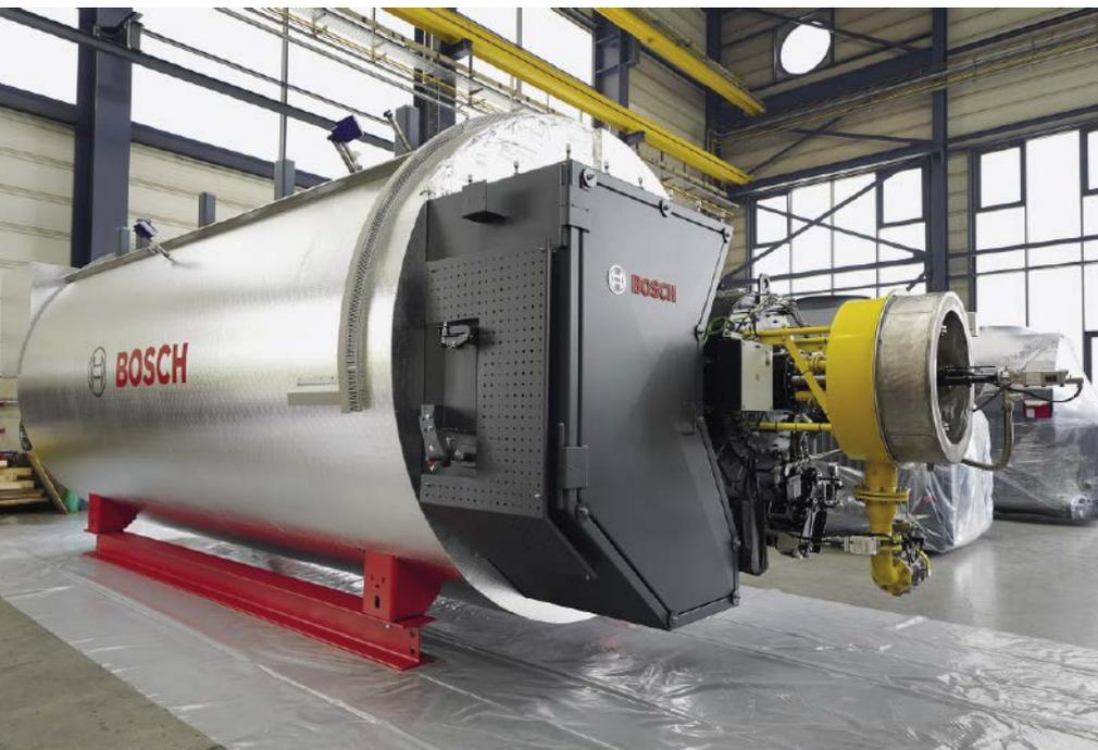
■ Abb. 1: Ein Dampfkessel für eine Referenzanlage in Polen zum Betrieb mit Wasserstoff und Erdgas.
