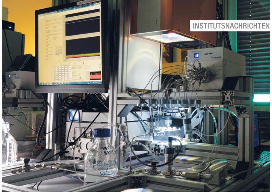
Photokatalytische Membranfiltrationsanlage mit Sonnensimulator. Die Membranen sind mit Titandioxid beschichtet.
