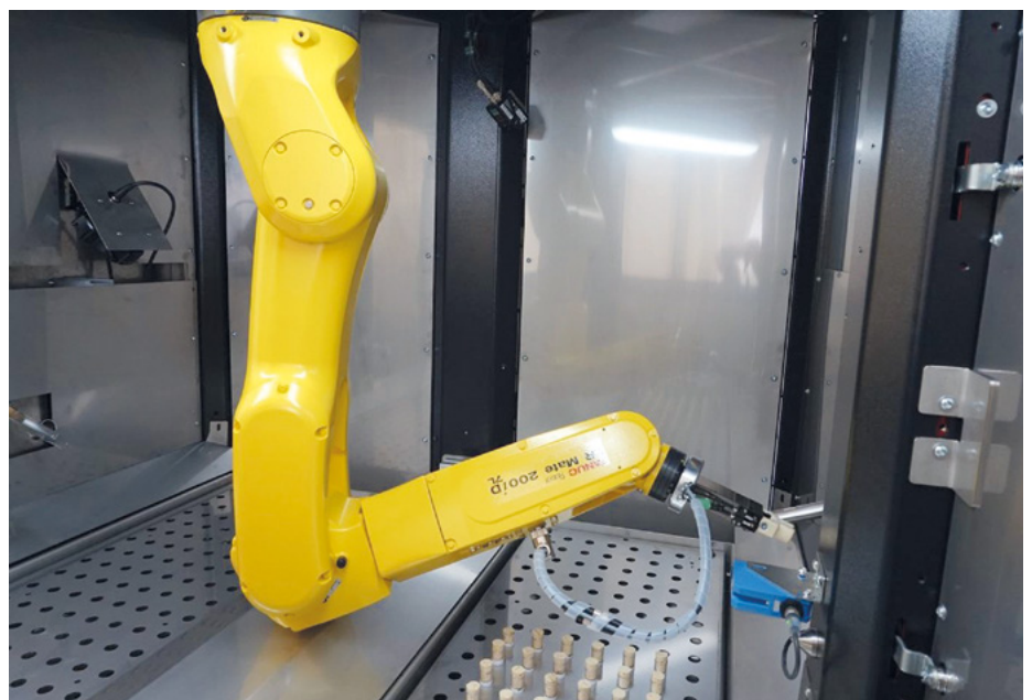
Abb. 1: BoKa Automatisierung hat eine Roboterzelle mit einem Fanuc-Roboter entwickelt, um die Abwicklung von Coronatests im Drive-Through-Verfahren schneller und sicherer zu machen.
