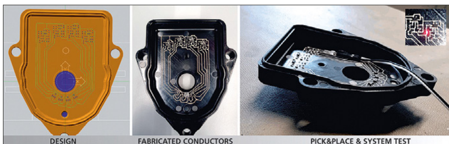
Abb. 1: CAD/CAM-Prozesskette für die Beschichtung von 3D-Objekten, hier am Beispiel einer Magnetfeldsensorik auf einer Getriebekappe demonstriert.
