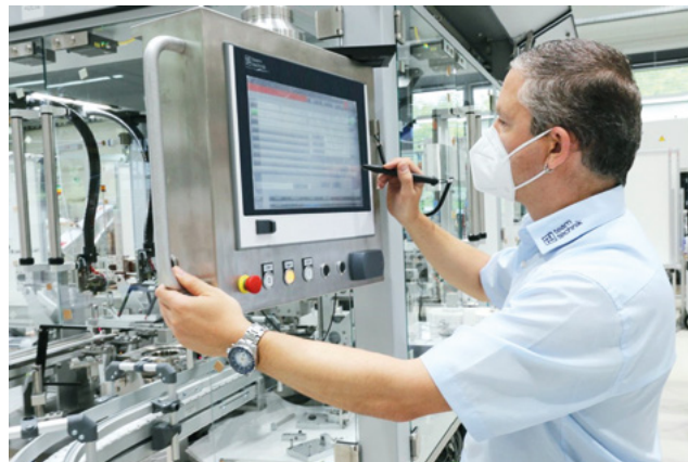
Abb. 4: Teamtechnik nimmt eine komplexe Montage- und Prüfanlage für ein Corona-Diagnostikprodukt in Betrieb.
