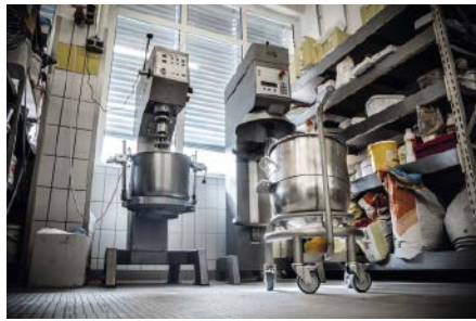
■ Abb. 3: Thermoplast-Räder bieten mit der bodenschonenden grauen Bereifung hohen Fahrkomfort, ohne Spuren zu hinterlassen. Zudem verfügen sie über einen geräuscharmen Lauf, sind stoßfest und haben nur einen geringen Rollwiderstand.
