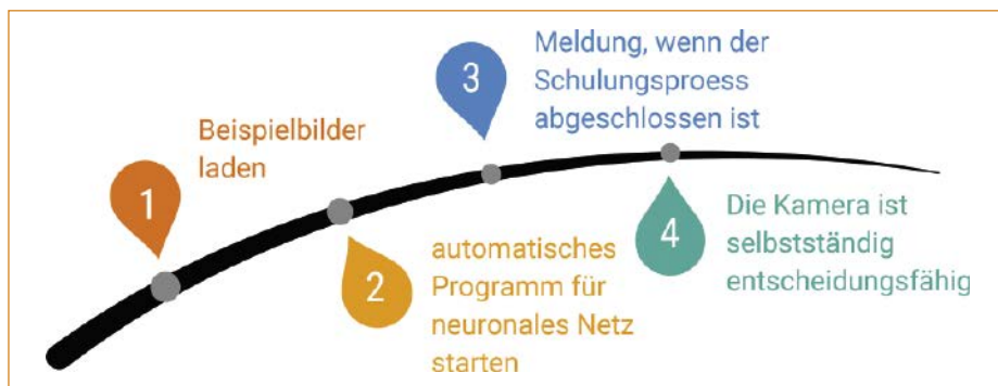
■ Abb. 3: Nur vier Schritte sind erforderlich, bis die smarte AI Kamera selbstständig Entscheidungen trifft.
