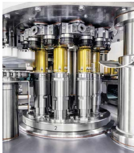
■ Abb. 2: Ferrum legt bei seinen Verschleißern größten Wert auf das hygienische Design aller Komponenten. Der Verschleißbereich ist vollständig aus Edelstahl gefertigt.
