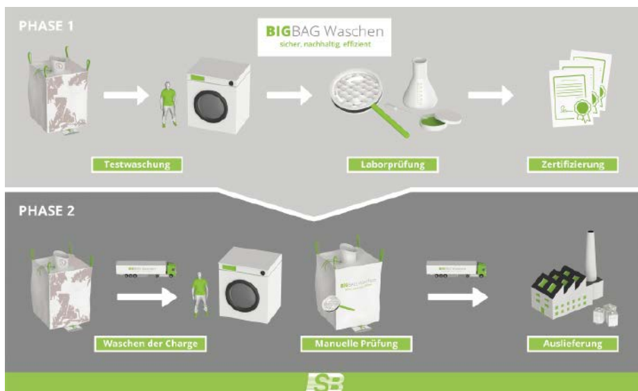
■ Abb. 2: Ablaufschema der Big Bag Waschung bei SB Clean in zwei Phasen.
