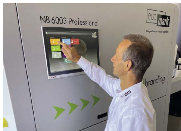
■ Abb. 3: Richard Neuhoff bedient die Natural Branding-Anlage über ein Touch-Interface. So können die Lasereinstellungen unkompliziert auf die aktuelle Produktgruppe und deren Eigenschaften abgestimmt werden.
