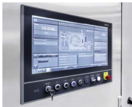
■ Abb. 3: Smarte Technik: Sowohl die Dosenfüller von KHS als auch die Ferrum-Verschleißer sind mit modernen HMI-Panels ausgestattet, die die Arbeit des Bedienpersonals deutlich erleichtern.
