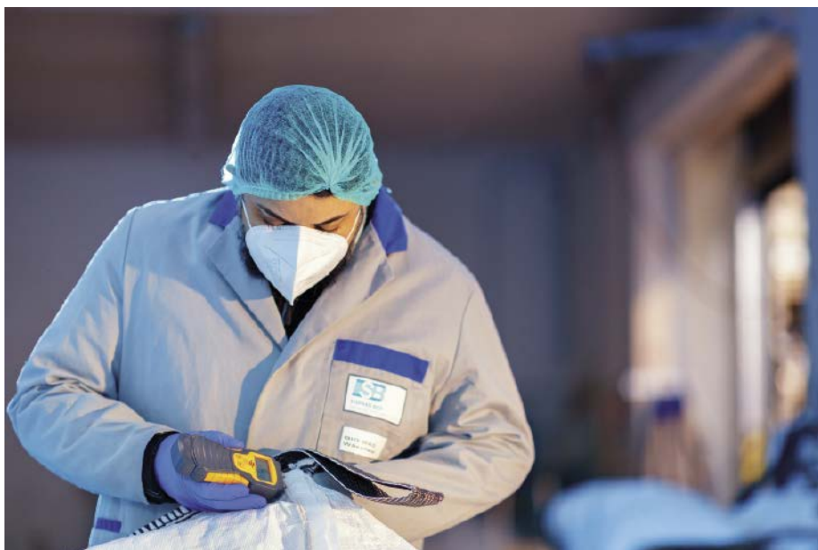
■ Abb. 1: Feuchte-Kontrollmessung der Big Bags. Die Restfeuchte der getrockneten Big-Bags muss bei nahezu 0,0% liegen, da sonst die Gefahr von Schimmelbildung besteht.
