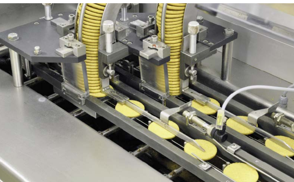
■ Abb. 1: Für die Klassifizierung von komplex zu unterscheidenden Objekten ist die Vision Cam AI.go optimal.
