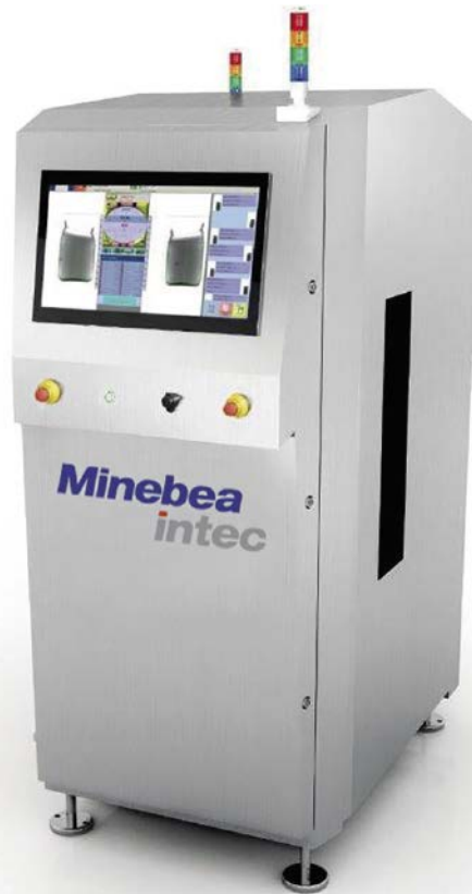
■ Abb. 2: Das Röntgeninspektionssystem Dymond DSV nutzt im „Dual Split View“-Verfahren die natürliche Aufweitung der Röntgenstrahlen und das Röntgenbild des Produkts wird beim Eintritt in den Strahlungskegel sowie auch bei Austritt aufgezeichnet.
