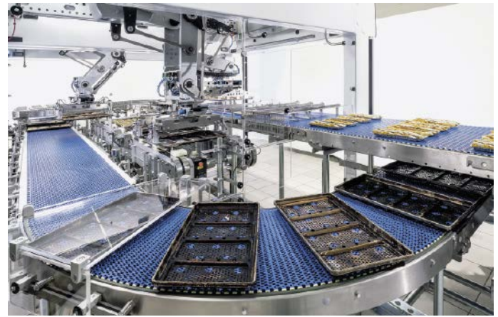
■ Abb. 3: Eine einzigartige Bypass-Funktion vermeidet Blechstau bei einem unvorhergesehenen Stopp der Maschine und erhöht dadurch die Flexibilität der Anlage.
