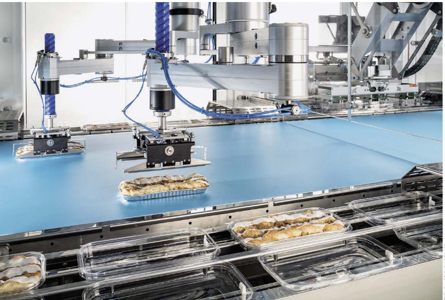
■ Abb. 1: Nach der Qualitätskontrolle werden die Danish von F4-Robotern einzeln in die Clamshells (Muschelschalenverpackungen) eingesetzt.
