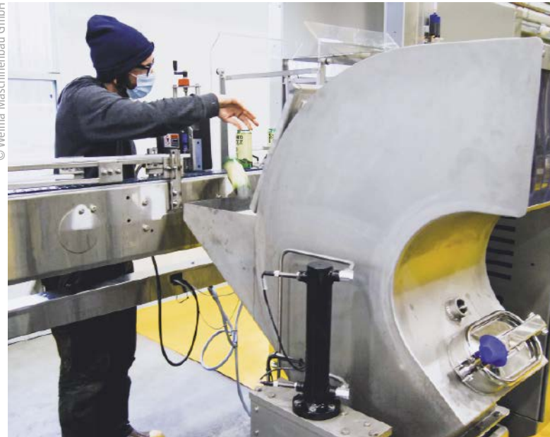
■ Abb.: Seit Ende 2021 erweitert eine Entwässerungspresse des Typs Puehler E.200 den Maschinenpark der Fiddlehead Brewing Company.
