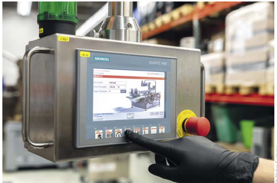
■ Abb. 2: Alle spezifischen Etikettierparameter sind in der SPS der Etikettieranlage gespeichert, wenn sie korrekt eingestellt wurden, gibt die SPS „grünes Licht“ für den Etikettiervorgang.
