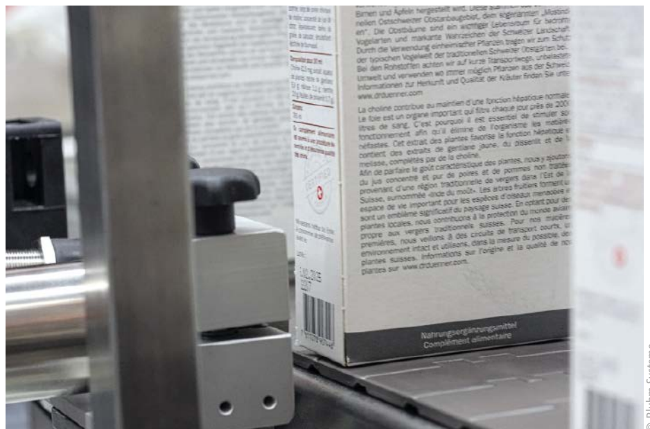
■ Abb. 3: Tinte und Filter des Linx 8920 müssen im Schnitt nur alle zwei Jahre gewechselt werden. Die Fälligkeit wird frühzeitig angekündigt, damit sie in Produktionspausen verlegt werden kann.
