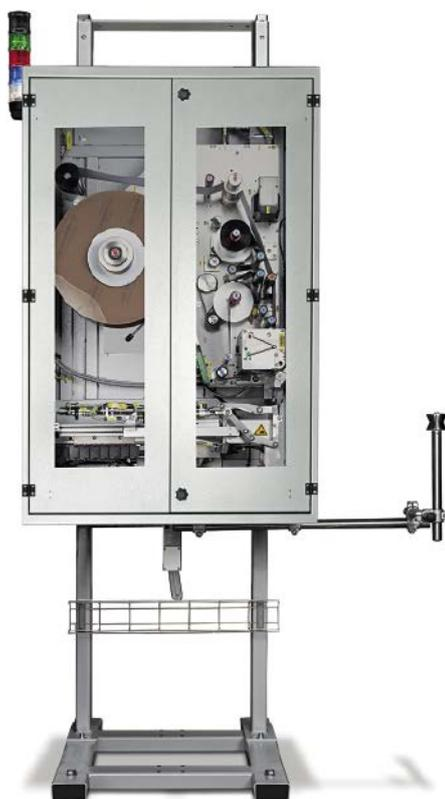
■ Abb. 3: Das Schnur-Etikettiersystem Logomatic 920 PSCK sichert ladungsstabile beladene Getränkepaletten und appliziert im gleichen Arbeitsgang Etiketten so, dass sie nicht auf den Kisten selbst haften, sondern an der Sicherungsschnur.
