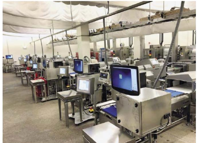
■ Abb. 3: Integration neuer Bizerba-Verwiege- und Etikettiermaschinen in das ERP-System.
