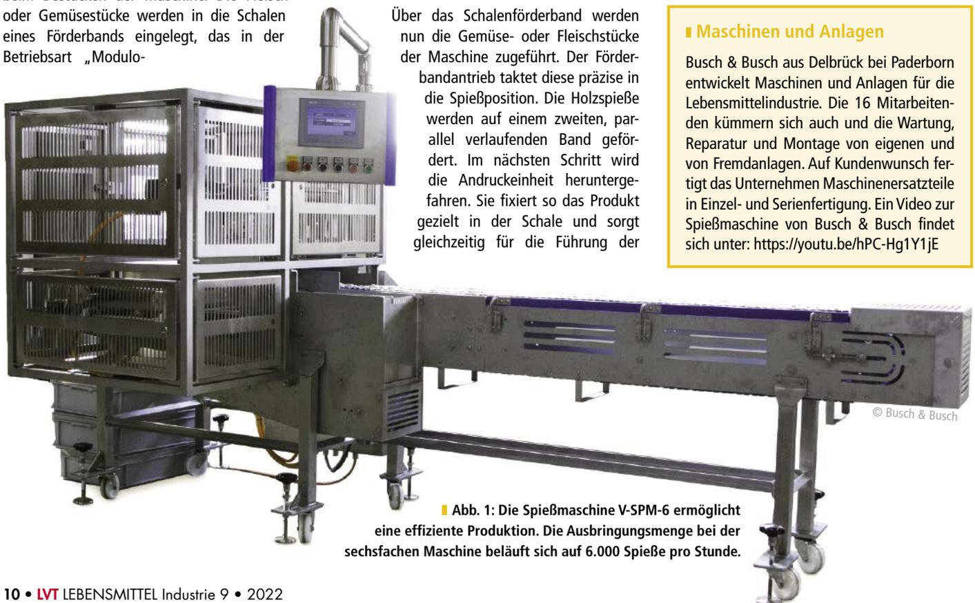
■ Abb. 1: Die Spießmaschine V-SPM-6 ermöglicht eine effiziente Produktion. Die Ausbringungsmenge bei der sechsfachen Maschine beläuft sich auf 6.000 Spieße pro Stunde.
