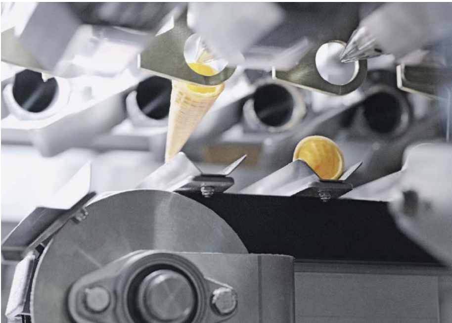
■ Abb. 4: Am Ende des Prozesses wird die Waffel zu einer spitzen Tüte geformt.
