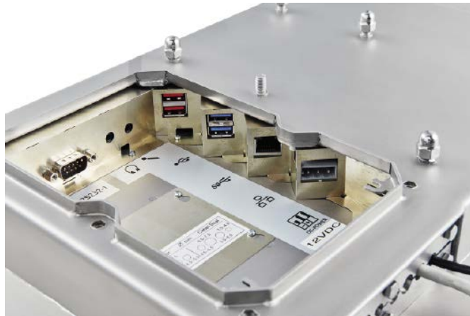
■ Abb. 3: USB, Bluetooth, WLAN und andere gängige Schnittstellen gewährleisten bereits ab Werk eine schnelle und reibungslose Integration der IPCs in vorhandene MES-, ERP und IT-Umgebungen.
