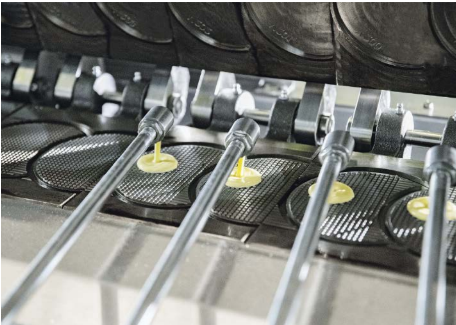
■ Abb. 2: Der Formprozess bei einer typischen Waffel am Beispiel von Eistüten: Der Teig wird auf einzelne Backplatten aufgegossen, ...
