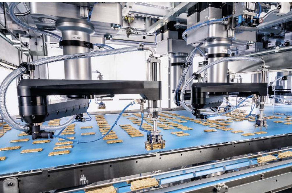
■ Abb. 1: Pick-and-Place-Roboter greifen Backwaren auf und setzen sie millimetergenau ab. Im Bild zu sehen sind Pick-and-Place-Roboter, welche die Kekse zu Stapeln gruppieren, bevor sie weiter verpackt werden.
