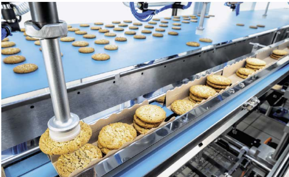
Abb. 2: Spezielle Werkzeuge, die genau auf das jeweilige Format abgestimmt sind, wie hier das Saugerwerkzeug am Pick-and-Place-Roboter, können sich die Unternehmen per 3D-Druck einfach selbst drucken.
