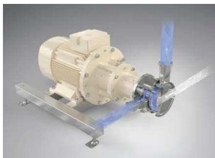
■ Abb. 2: Mit der Pulverbenetzungs- und Dispergiermaschine Ystral Conti-TDS können auch schwer zu benetzende, staubende oder klebende proteinhaltige Pulver agglomeratfrei dispergiert werden. Der Partikelauflschluss kann dabei in kalter oder warmer Flüssigkeit erfolgen.
