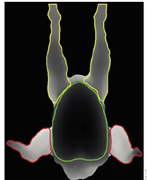
■ Abb. 2: Hochauflösende 3D-Aufnahmen der Vor- und Rückseite jedes Huhns bestimmen deren Volumenwerte, um daraus korrekte Gewichtsdaten abzuleiten.
