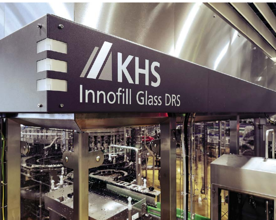
■ Abb.: Das modulare Füllsystem Innofill Glass DRS ECO erlaubt eine sauerstoffarme Abfüllung, die es in dieser Form bisher nicht gab.
