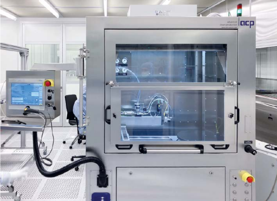
Die reinraumgerecht ausgelegte und ausgestattete JetStation-HP wurde für die flexible Reinigung bei höchsten Anforderungen an die Sauberkeit entwickelt. Sie wird manuell beladen und kann automatisiert oder teilautomatisiert als Standalone-Lösung betrieben werden.
