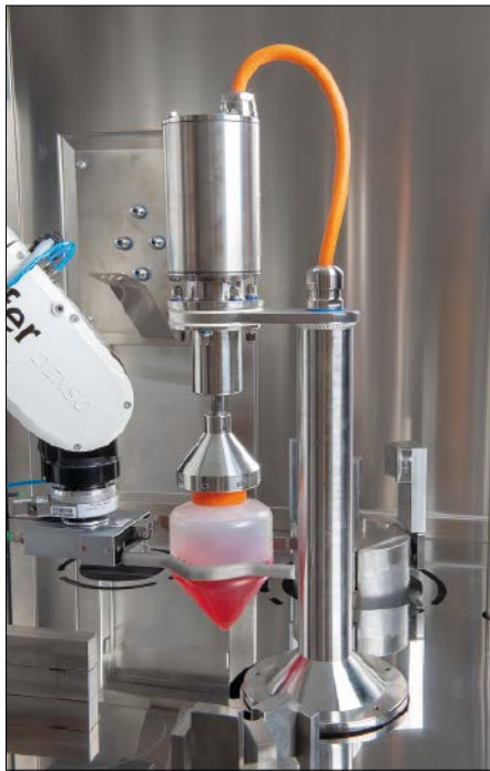
Abb. 2: Beispielanwendung bei der ein 6-Achs-Roboter zum entdecken einer Zentrifugenflasche den Cap-Screwer verwendet.
