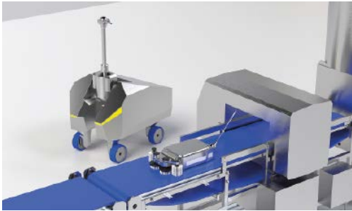
MCD und Inline MCD: Intelligente Reinigungsroboter für die automatisierte und reproduzierbare Reinigung von Anlagen und Produktionsumgebungen.
