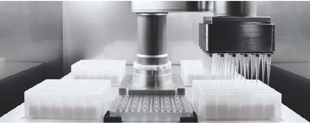
Abb. 1: Automatisierte Zellanalyse: Für jede der 24 Pipetten am Roboterarm kann eine andere Zusammensetzung der Lösung gewählt werden.
