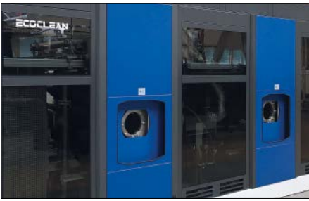
Abb. 1: Die Konstruktion und spezielle High Purity-Ausstattung der Doppelkammeranlage für wasserbasierte Medien ermöglicht die effiziente Reinigung auch großer Bauteile, bei der Sauberkeitsspezifikationen entsprechend Grade 2 stabil erreicht werden.
