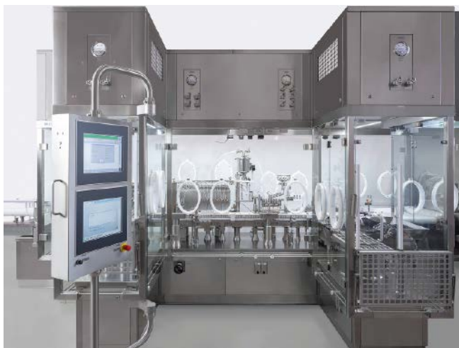
Abb. 2: Die MLD 3061 von Syntegon ist für den mittleren Ausbringungsbereich geeignet und kann bis zu 300 Karpulen pro Minute verarbeiten.
