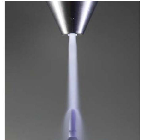
Das Zusammenspiel der Wirkmechanismen der QuattroClean-Schneestrahntechnologie ermöglicht, partikuläre Verunreinigungen bis in den Submikrometer-Bereich und feinste filmische Kontaminationen prozesssicher und reproduzierbar zu entfernen.
