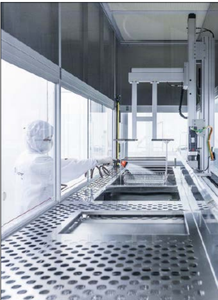
Abb. 3: Konstruktion, Verarbeitung und Ausstattung der Anlagen verhindern, dass es zu Re- und Kreuzkontaminationen kommt. Sie sind ausgelegt für eine Anbindung bzw. Integration in einen Reinraum.
