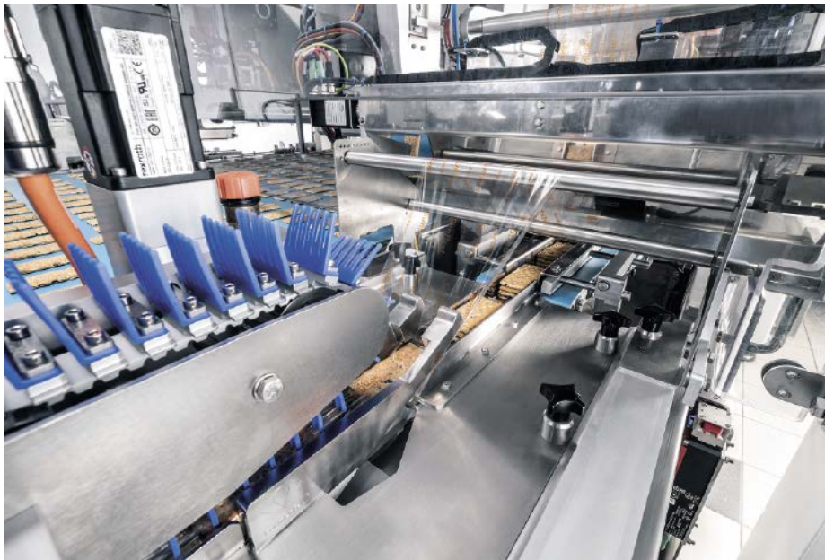
■ Abb. 2: Nach der Zuführung per Pick-and-Place sorgt die flexible Siegeltechnologie im Flowpacker für ein sicheres Verschließen der Schlauchbeutel, egal ob bei herkömmlichen oder recycelbaren Folien.
