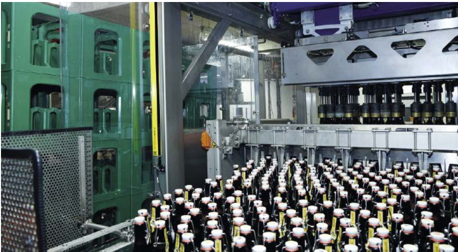
■ Abb. 4: Reflexions-Lichtschränken der Leuze Serie PRK sind in der Abfüllung an vielen Stellen zu finden – hier erfassen sie in Sekundenbruchteilen jede einzelne Flasche. Selbst hochtransparente Objekte sind für die Sensoren kein Problem.
