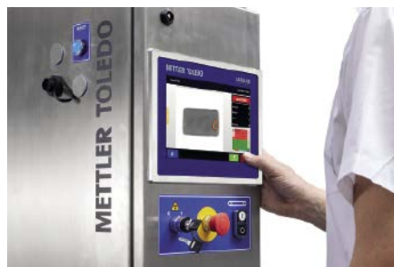
■ Abb. 5: Ein neues Röntgeninspektionssystem von Mettler-Toledo wurde für die Fremdkörpererkennung in kleinen, einzeln verpackten Snacks und Süßwaren entwickelt.
