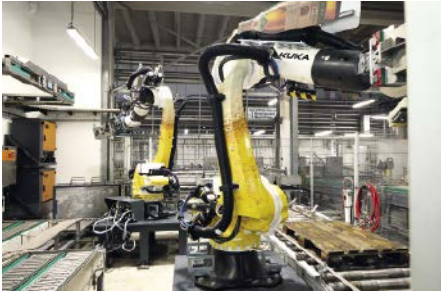
■ Abb. 2: Hier muss keiner schwer heben: In der Fass-Abfüllung greifen zwei moderne Roboter die Bierfässer und setzen sie auf Förderbänder oder Paletten.
