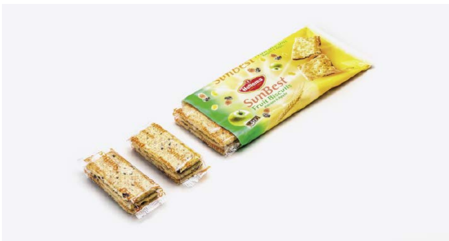
■ Abb. 3: Die Kekse des niederländischen Unternehmens Hellema sind einzeln, als Zweier- oder Dreierstapel in Schlauchbeuteln verpackt, die dann in Kartonschachteln oder Multipack-Schlauchbeuteln verpackt werden.
