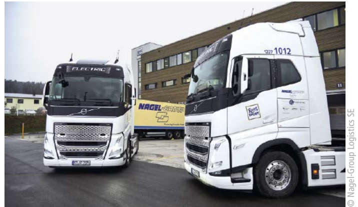
■ Abb. 1: Die beiden E-Lkw haben je eine Leistung von 490 KW, was 666 PS entspricht. Bei einem Gesamtzuggewicht von 44 t erreichen sie laut Hersteller eine Reichweite von 300 km.
