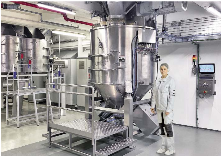
■ Abb.: Amixon Konusmischer mit 3.000 l Nutzvolumen; aufgrund der Bauart sind ideale Mischgütern bereits bei einem Füllgrad von ca. 5% zu erreichen.
