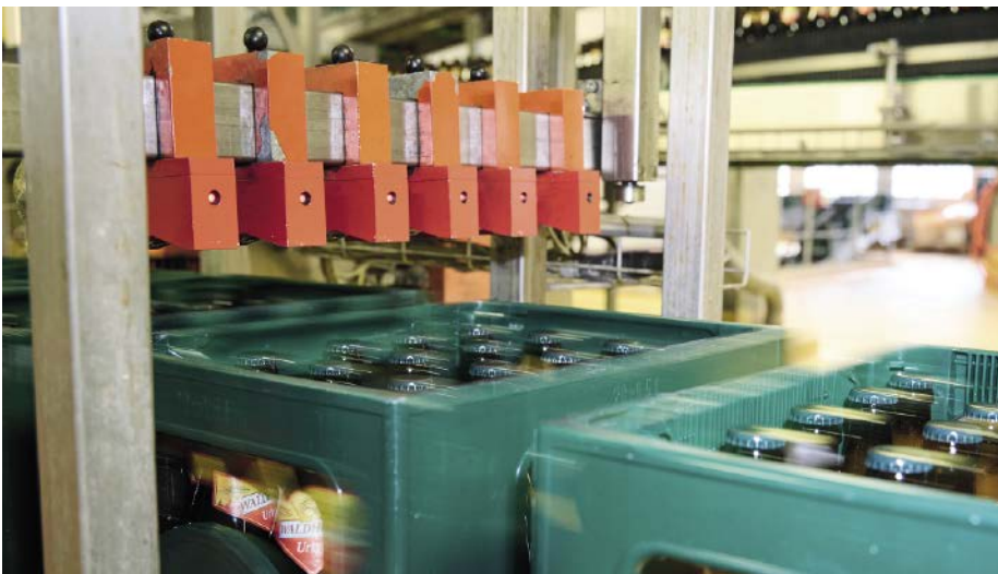
■ Abb. 5: Den Sensoren über dem Förderband entgeht nichts: Fehlt eine Flasche oder liegt eine quer im Bierkasten, erfassen sie das sofort.
