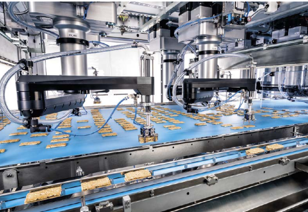
■ Abb. 1: Mit Pick-and-Place-Anwendungen können Hersteller eine profitable Verpackungsleistung erzielen und gleichzeitig die gestiegenen Anforderungen an vielfältige Produktsortimente wie Mischpackungen und wechselnde Verpackungsformate erfüllen.
