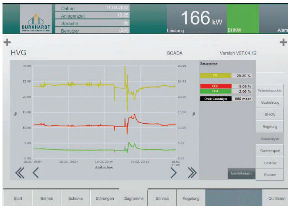
Diagramm zur Gasanalyse mit live \text{CH}_4 / \text{CO} - und \text{CO}_2 -Messwerten.
