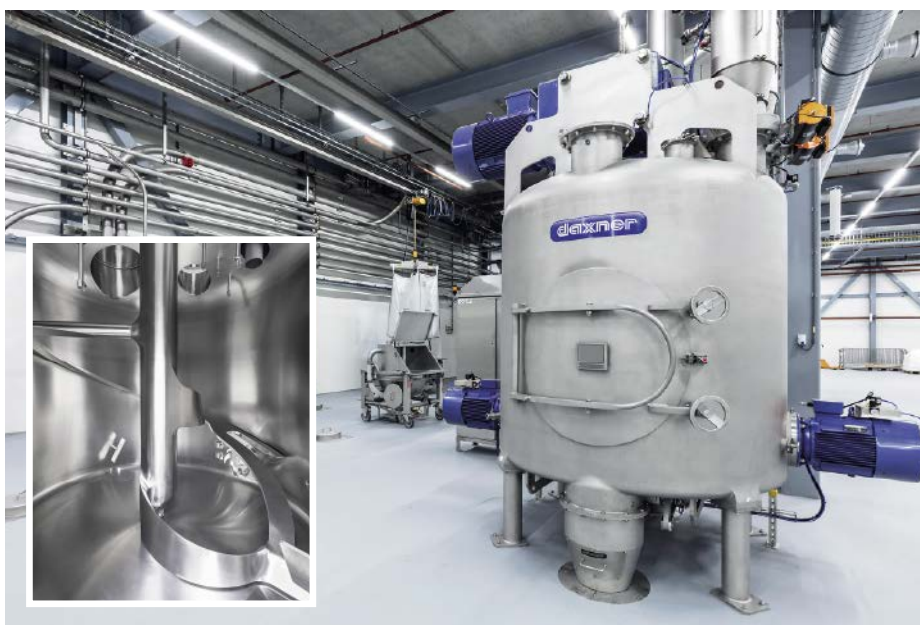
■ Abb. 5: Ein vertikaler Hochleistungsmischer in Hygienic Design erzielt schnelle Mischungen mit sehr hoher Mischgenauigkeit inklusive vollautomatischer Trocken- und Nassreinigung.
