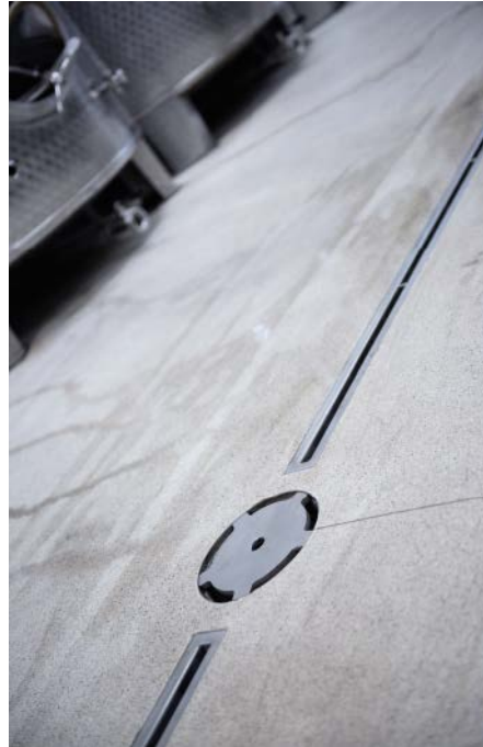
■ Abb. 3: Der Bodenablauf Eurosink Junior von Aschl besitzt einen integrierten Edelstahl-Schmutzfangkorb sowie einen Geruchsverschluss. Dank der herausnehmbaren Abdeckungen lassen sich Rinnen und Bodenabläufe ganz einfach ausspülen.
