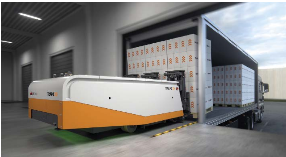
■ Abb. 2: Das autonom agierende Be- und Entladesystem entzerrt den Gefahrenbereich zwischen Lager und Lkw.
