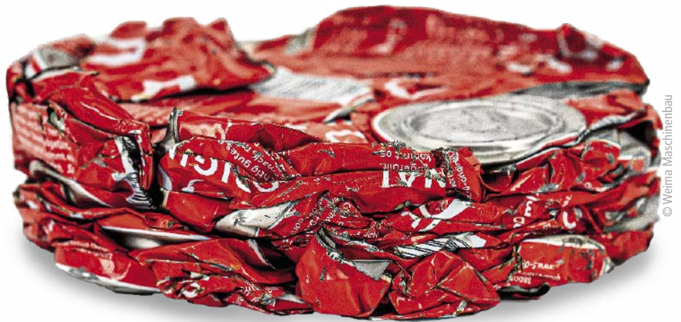
■ Abb. 1: Kompakte Bierdosen-Presslinge mit 200 mm Durchmesser reduzieren das Frachtvolumen im Rohstoffkreislauf.
