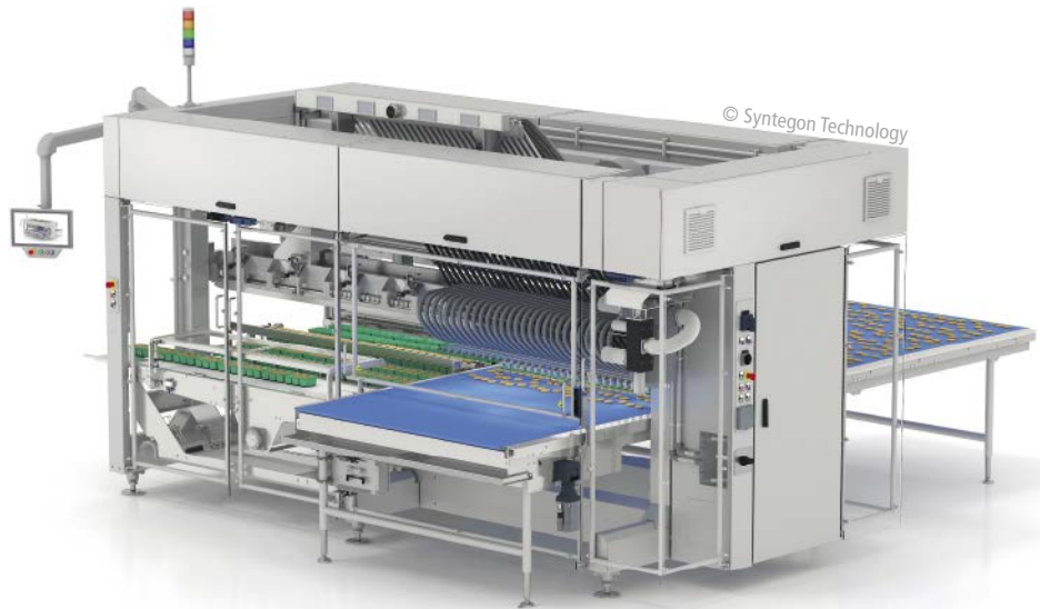
■ Abb. 2: Eine neu entwickelte Pickertechnologie auf Basis von Linearmotoren gewährleistet dank gleichmäßiger Bewegungen ein besonders schonendes Handling.
