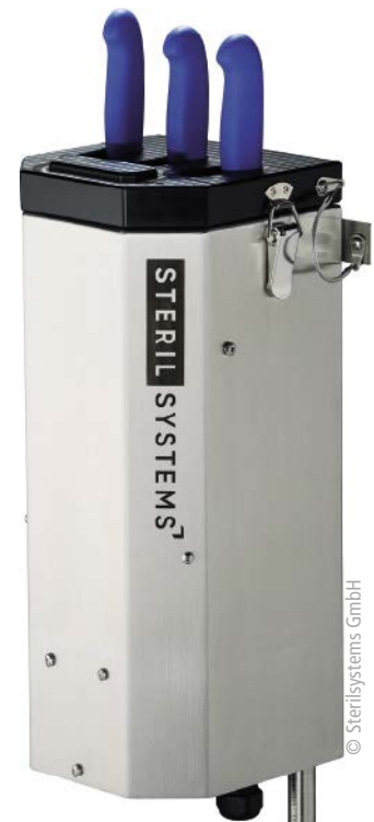
■ Abb. 2: Die wasserdichten UV-C-Strahler der MD3S befinden sich im Inneren des Gehäuses, dessen Klappen an den Messersteckplätzen automatisch durch die Schwerkraft schließen.
