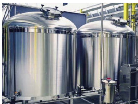
■ Abb. 3: Auch große Behälter oder Edelstahlwaschmaschinen lassen sich nun ohne Inertisierung reinigen.
