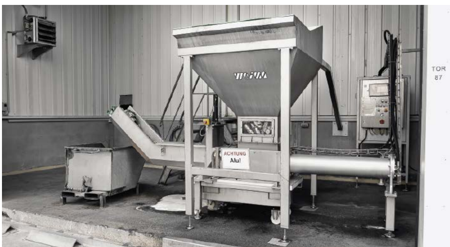
■ Abb. 2: Entwässerungspressen von Weima Maschinenbau bei der Oettinger Brauerei.
