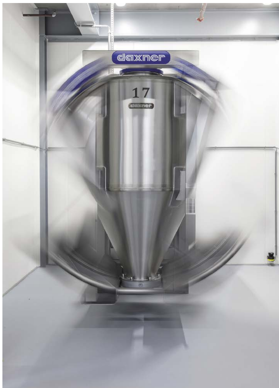
■ Abb. 3: Container Mischer für das Mischen einer Charge von Komponenten im Container.
