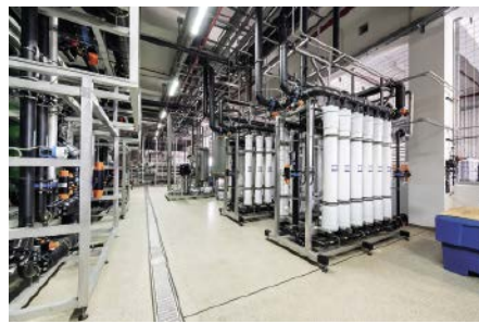
■ Abb. 2: Mit einer Recyclinganlage für Brüdenkondensate spart eine Molkerei Frischwasser und entlastet ihre Abwasserbehandlungsanlage.
