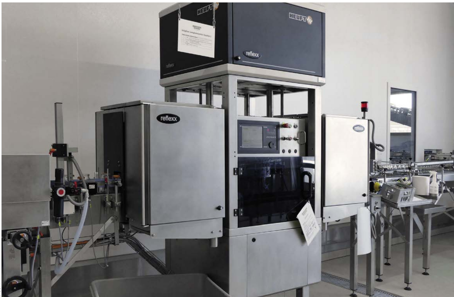
■ Abb. 3: Die Gläser laufen durch einen Leerglasinspektor der Firma Heuft Systemtechnik. Er prüft die Gläser auf mögliche Materialfehler sowie das Vorhandensein von Restflüssigkeiten. Anschließend laufen die Gläser über ein Förderband durch ein Gebläse, das sie trocknet.
