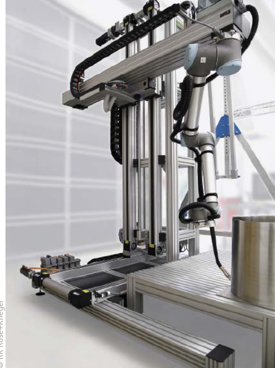
■ Abb. 3: Für ein robotergestütztes Handling- und Bearbeitungsportal kombinierte RK Rose + Krieger vier Linearachsen vom Typ RK Duoline Z 80 Protect, eine rollengeführte Linearachse RK Monoline Z 120 und diverse Aluminiumprofile aus dem Blocan-Baukasten.
