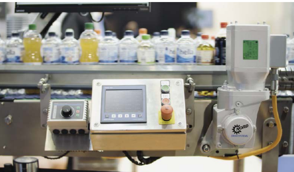
■ Abb. 1: In Branchen mit besonderen Hygieneanforderungen wie der Getränkeindustrie kommen Antriebskomponenten mit nsd tupH Oberflächenveredelung zum Einsatz.
