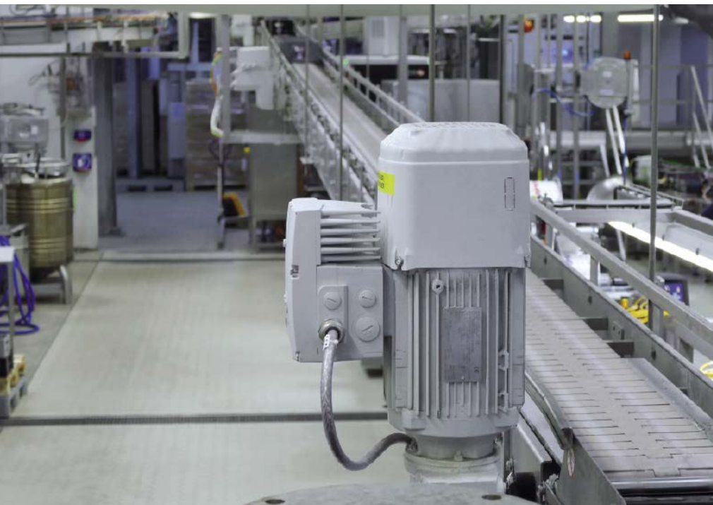
■ Abb. 4: Dieses Förderband leitet die Joghurt-Stiegen zur Logistik weiter. Es wird durch dezentrale Antriebe Movigear performance von SEW-Eurodrive angetrieben. Movimot performance – vorn im Bild – sorgt für den kraftvollen Antrieb des vorgelagerten Spiralförderers.
