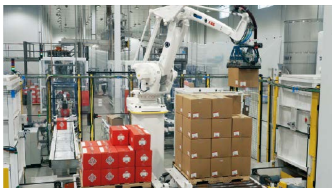
■ Abb. 4: Der Palettierroboter IRB 660 von ABB nimmt abwechselnd Kartons von jedem Förderband auf und baut parallel separate Paletten für jede Produktgröße.
