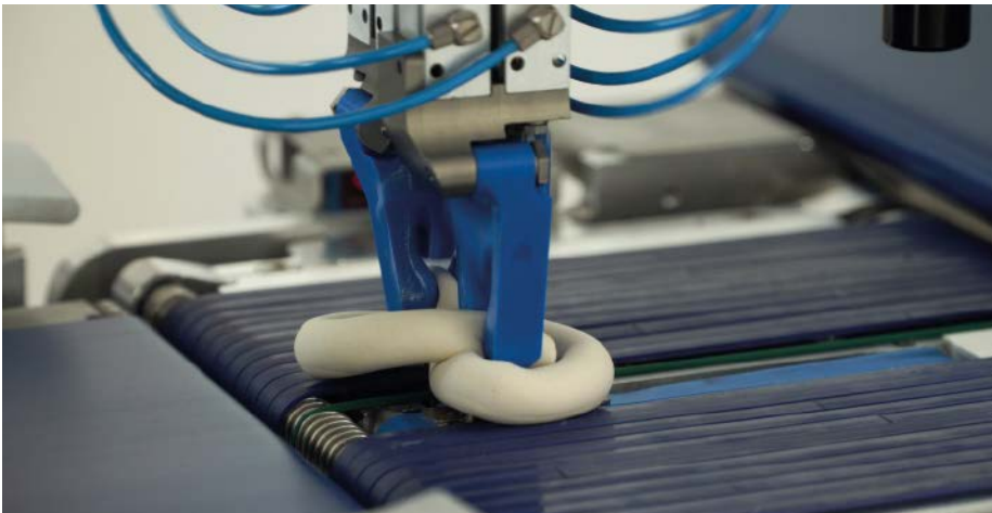
■ Abb. 3: Der Schlinger des Multitwists schließt den Teigknoten.
