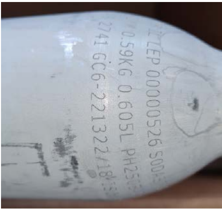
■ Abb. 2: Auf den Oberflächen der zylinderförmigen Flaschen sind verschiedene Informationen wie Seriennummern, Produktdaten, Abfülldatum und Logo per Laser eingraviert.
