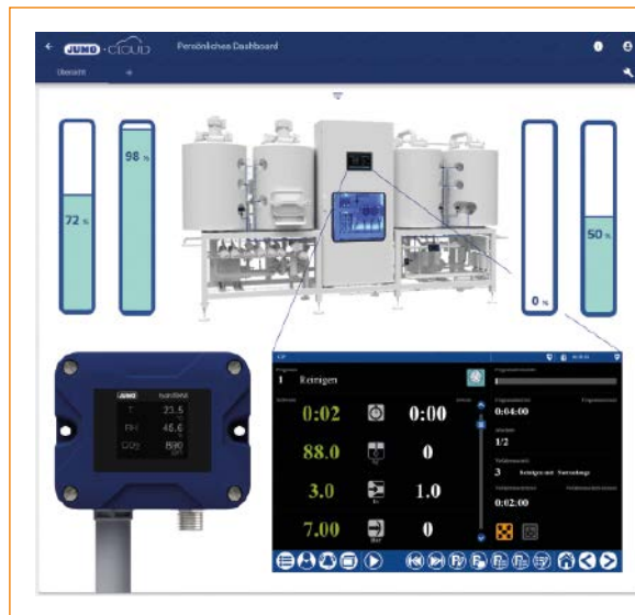
■ Abb. 2: Von Maischen und Abläuern über das Würzkochen und -kühlen bis hin zur Gärung und Filtration – alle Prozesse können mit der Jumo-Lösung effizient gesteuert werden.
