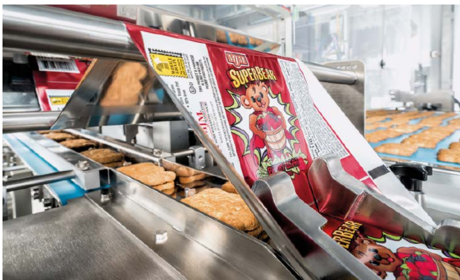
■ Abb. 3: Dank der flexiblen Siegeltechnologie von Schubert kann der Kunde ohne großen Aufwand von Kaltsiegelung auf Heißsiegelung umsteigen.
