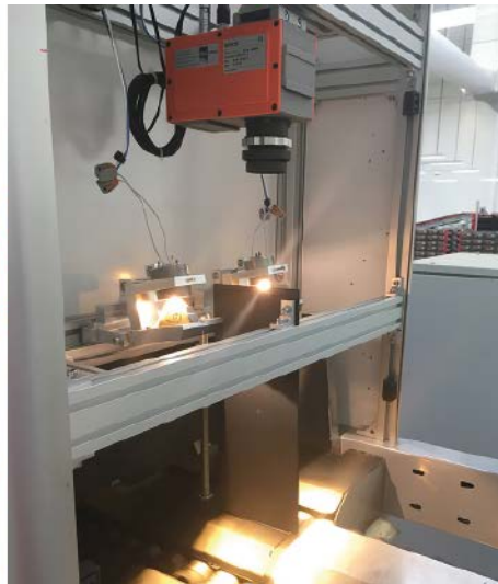
■ Abb. 2: Eine Specim FX17 Hyperspektralkamera ist die technische Grundlage für die Analyse des Geschmacks von Gemüse, Obst und anderen Lebensmitteln, um die Rentabilität des Verkaufs zu optimieren und Lebensmittelabfälle zu reduzieren.
