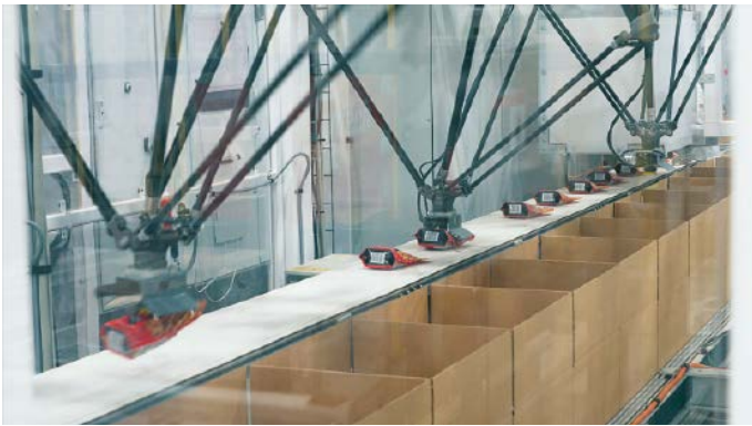
■ Abb. 2: Die zwei parallele Verpackungslinien bei Dot's sind mit drei ABB-Deltarobotern vom Typ IRB 360 Flexpicker für die kleineren Tüten sowie zwei Flexpickern für die Größeren bestückt. Die Deltaroboter nehmen die Verpackungen von einem Förderband und platzieren sie mit unterschiedlichen Vakuumgreifern in Kartons.
