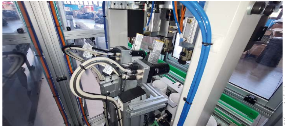
■ Abb. 3: Eine Zeilenkamera tastet die Flasche ab und nimmt so ein zweidimensionales Bild ihrer gekrümmten Oberfläche auf.
