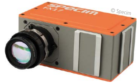
■ Abb. 3: Die Hyperspektralkameras Specim FX17 basieren auf einem InGaAs-Sensor und decken 224 Wellenlängenbänder im Nahinfrarotbereich (NIR) von 900 bis 1.700 nm ab. Viele der geschmacksbeeinflussenden Eigenschaften von Agrarprodukten können in diesem Spektrum untersucht und analysiert werden.
