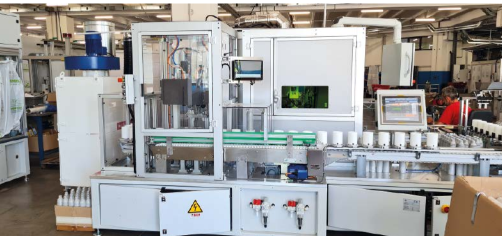
■ Abb. 1: Die automatisierte Identifizierung der Gefäße ist wichtig für reibungslose Produktionsabläufe sowie für die Qualität der ausgelieferten Flaschen.
