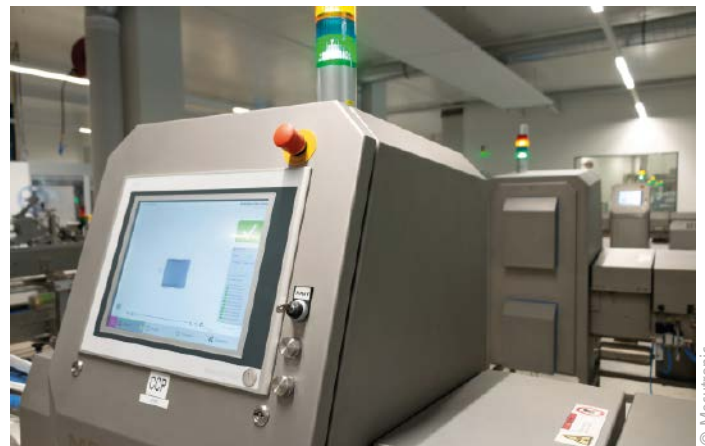
■ Abb. 3: Das Easyscope Röntgeninspektionssystem von Mesutronic erlaubt die präzise Fremdkörper-Detektion in den Qualitätsbackwaren trotz metallischer Verschlüsse an der Primärverpackung.
