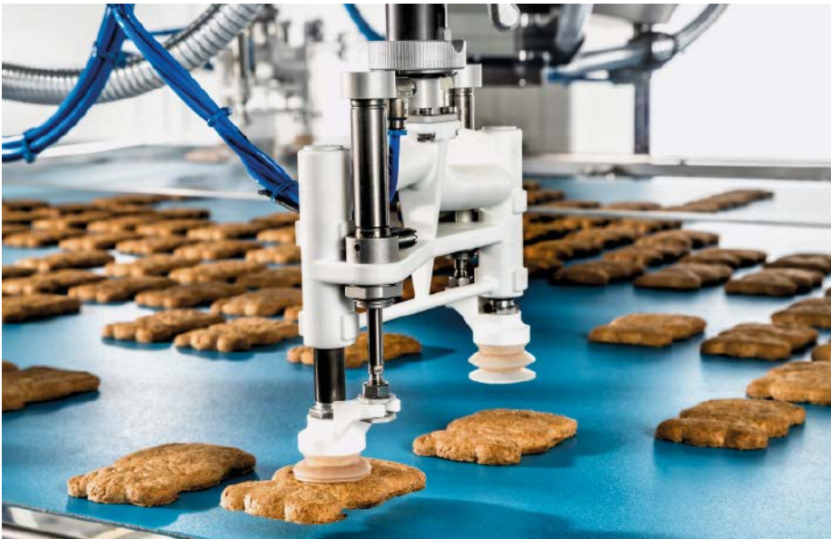
■ Abb. 2: 26 F4-Roboter nehmen die fertigen Kekse schonend per Doppelpick auf und legen sie in die Ketten der vier Flowmodule.
