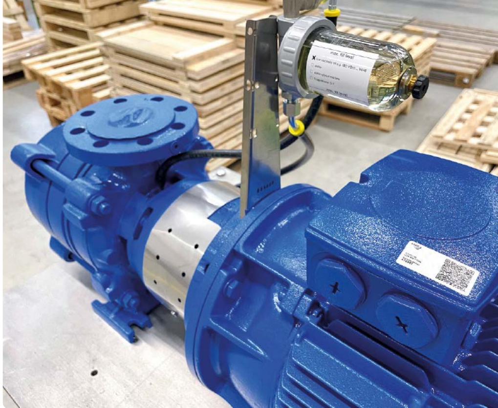
▲ Der digitale Produktausweis enthält die eindeutige Seriennummer, das Baujahr und zentrale technische Parameter wie Förderhöhe, Förderstrom oder maximal zulässigen Betriebsdruck der Pumpe.
