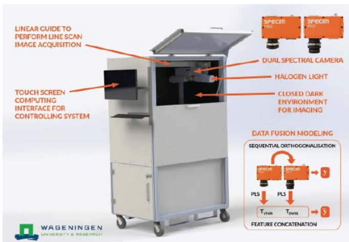
■ Abb. 2: Eine Illustration des All-in-One-Spektralkabinetts mit zwei Spektalkameras FX10 und FX17 von Specim. Die Datenmodellierung wird mit speziell entwickelten Datenfusionsmethoden durchgeführt.
