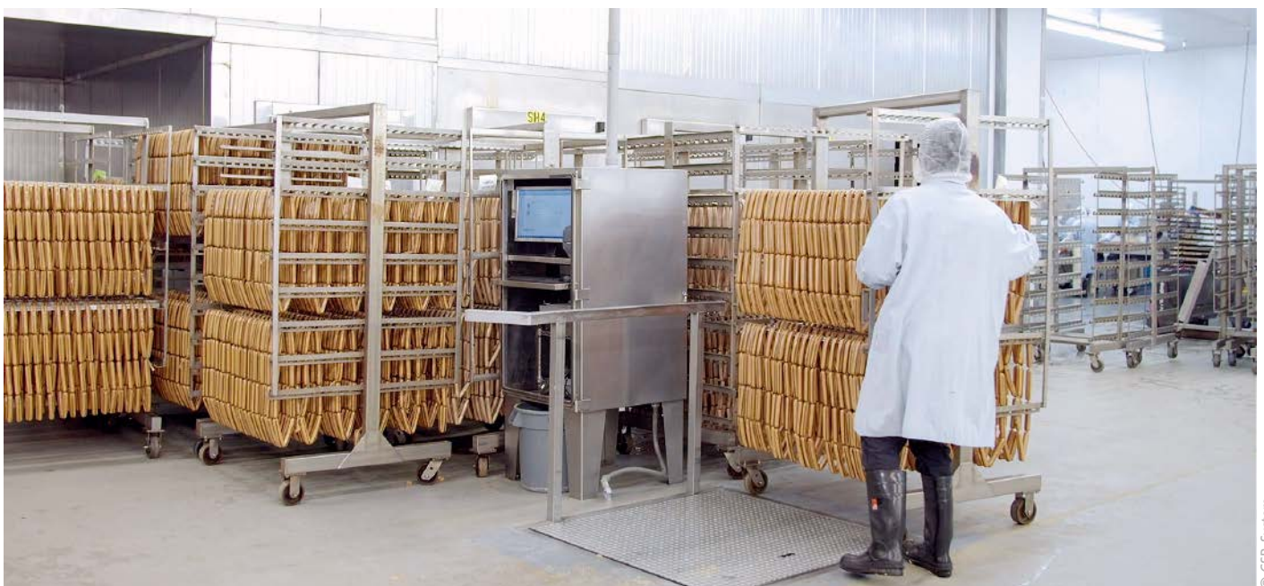
Abb. 1: Die Rauchkammern zeigten, welche Effizienzsprünge möglich sind. Courage produziert rund 350 verschiedene Artikel. Jeder davon kommt in eine der vier Rauchkammern und verliert dort an Gewicht. Nur: Wie viel genau und warum unterscheiden sich die Verluste in den Rauchkammern?
