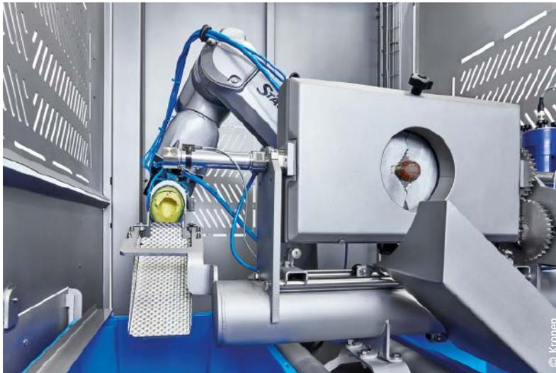
Mit der neuartigen Roboterlinie können Avocados effizient und schonend geschält, halbiert und entsteint werden. Die Anlage kann bei Bedarf adaptiert werden für die Verarbeitung verschiedener Obstsorten im Mittelsegment, die mit einem Roboter verarbeitet werden können. Die Linie ist beliebig erweiterbar. Sie kann um eine Schneidemaschine ergänzt werden. Integriert sind Roboter von Stäubli, die durch die speziell behandelte Oberfläche optimal gereinigt werden können. Die Anlage ist über
