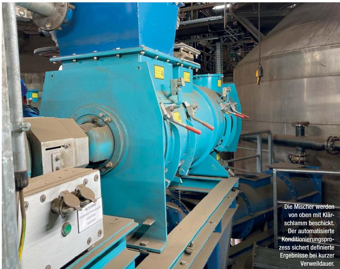
Die Mischer werden von oben mit Klärschlamm beschickt. Der automatisierte Konditionierungsprozess sichert definierte Ergebnisse bei kurzer Verweildauer.
