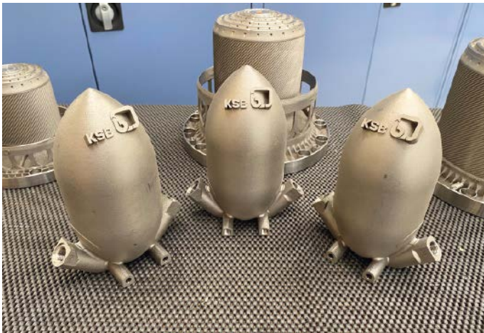
Additiv gefertigte MagnoProtect Bauteile vor der Montage
