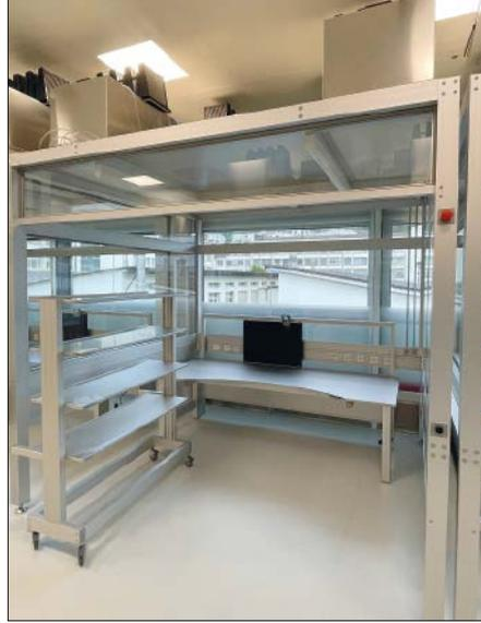
Die Mini-Environments bestehen aus Teilumhausungen auf Basis der item Aluminiumprofile mit integrierten Arbeitsplatzsystemen.
