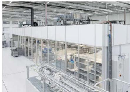
In der Reinraumanlage CleanCell 4.0 nach ISO 8 werden Kunststoffteile für hochreine Anwendungen montiert und verpackt
