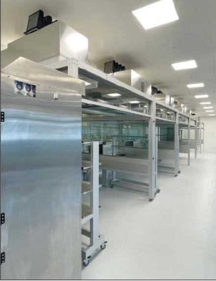
Für die sensiblen Produktionsprozesse im Reinraum stellt item mit den Mini-Environments eine ideale Arbeitsumgebung zur Verfügung. So entstanden 16 funktionale Montagezellen der Reinraumklasse ISO 5.
