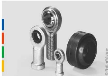
Abb. 3: Gelenklager eignen sich für Schwenkbewegungen und können damit Schiefstellungen ausgleichen.
