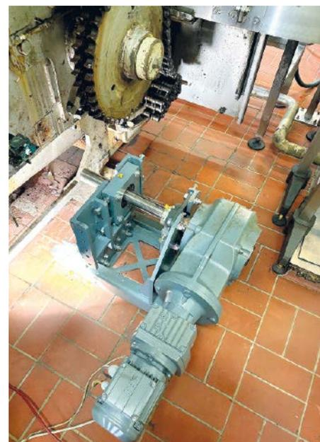
Vormontage der Antriebseinheit Pasteur Auslauf. Hier noch ohne Abdeckhaube und seitlicher Versteifung.
