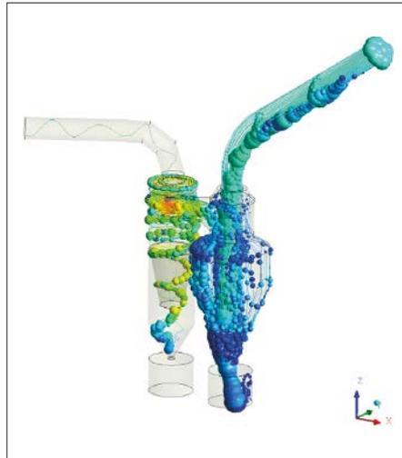
Abb. 3: Partikel-Tracking in den Abscheideapparaten
