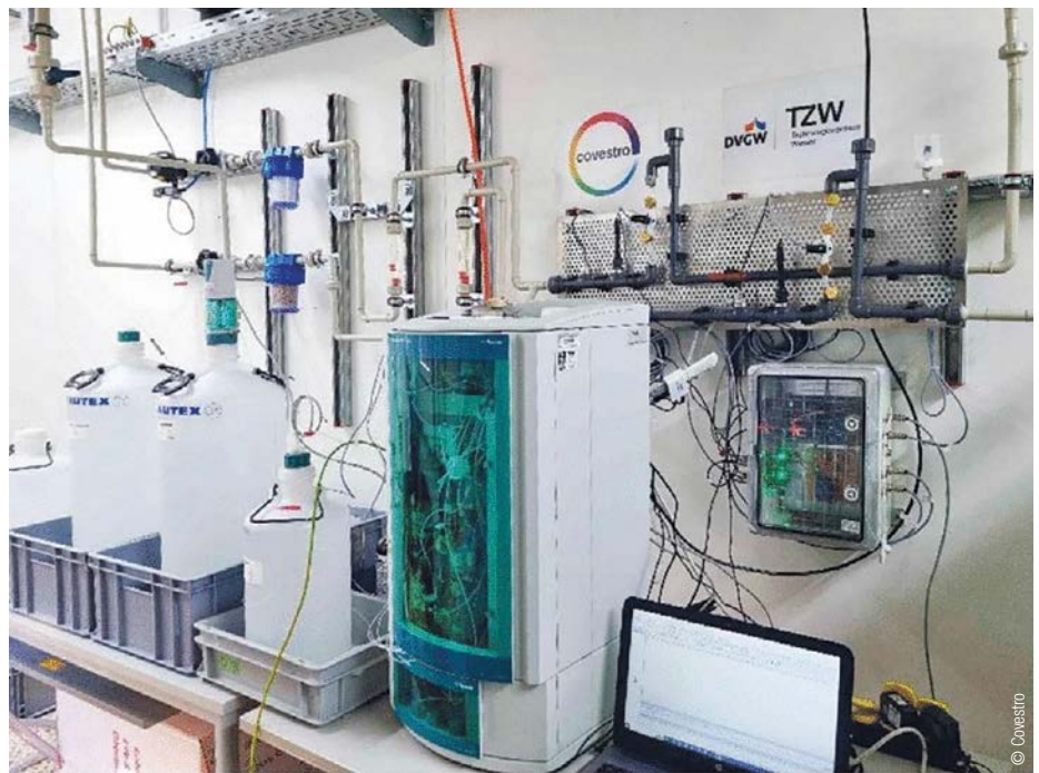
Abb. 2: Während der Pilotphase speziell angefertigtes Online-SPE-IC-CD-System am Covestro-Standort Uerdingen
