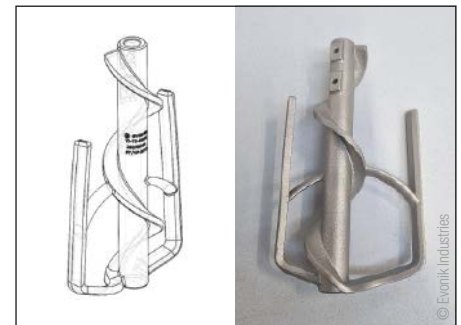
Abb. 4: 3D-gedrucktes Sonderrührorgan, rechts: 3D-Modell, links: gedrucktes Bauteil
