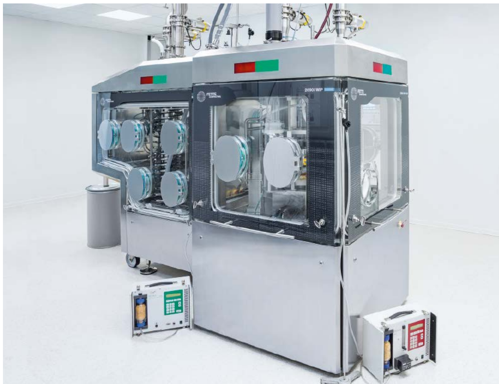
Abb. 3: Standardisierte Messverfahren wie der Containment Guard ermöglichen die systematische Überprüfung der Rückhalteleistung in verschiedenen Betriebszuständen.
