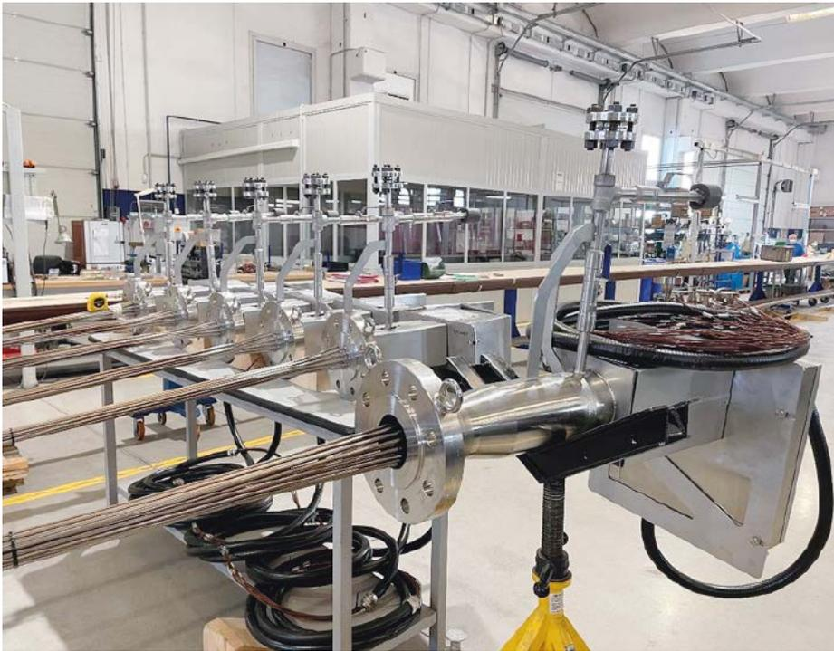
Für den Aufbau eines Temperaturprofils in Katalysatorbetten kommen vor allem Thermoelemente mit einer Mehrzahl flexibel positionierbarer Sensoren in Frage, wie bspw. Typ TC96 Flex-R.
