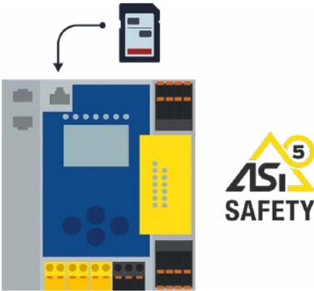
Im Austauschfall können die auf der SD-Karte gespeicherte Hardware- und Safety-Konfiguration sowie die Parameterdaten der angeschlossenen Geräte komplett auf ein neues, typengleiches Gateway übertragen werden.
