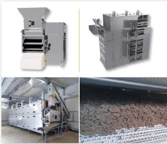
**Für pastöse Schlämme gibt es nun auch kontinuierliche Lösungen, um den hohen Wassergehalt zu reduzieren – Ein- und Mehrband-Trockner, alle mit Wärmepumpe.**
