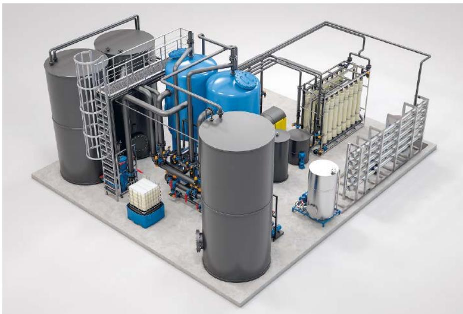
**3D-Modell der installierten Anlage, die jährlich 188.000 m<sup>3</sup> Wasser in Trinkwasserqualität produziert und dabei Brüdenkondensat als Wasserquelle nutzt.**
