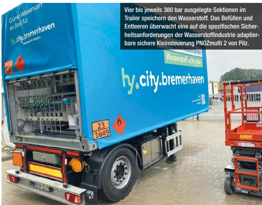
Vier bis jeweils 380 bar ausgelegte Sektionen im Trailer speichern den Wasserstoff. Das Befüllen und Entleeren überwacht eine auf die spezifischen Sicherheitsanforderungen der Wasserstoffindustrie adaptierbare sichere Kleinsteuerung PNOZmulti 2 von Pilz.
