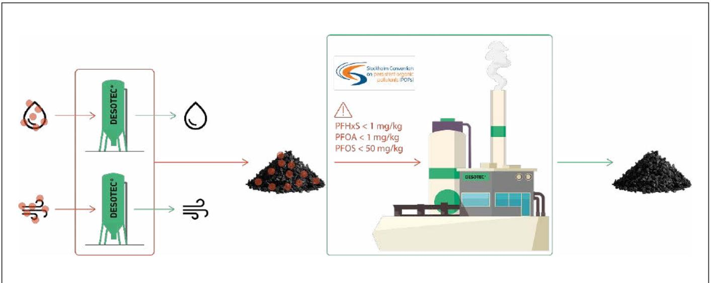
Abb. 2: Schema der Filtration von PFAS-belasteten Abwässern und Abgasen sowie nachgelagerter Reaktivierung unter technisch vollständiger Zerstörung der adsorbierten PFAS.
