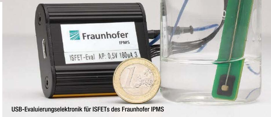
USB-Evaluierungselektronik für ISFETs des Fraunhofer IPMS
