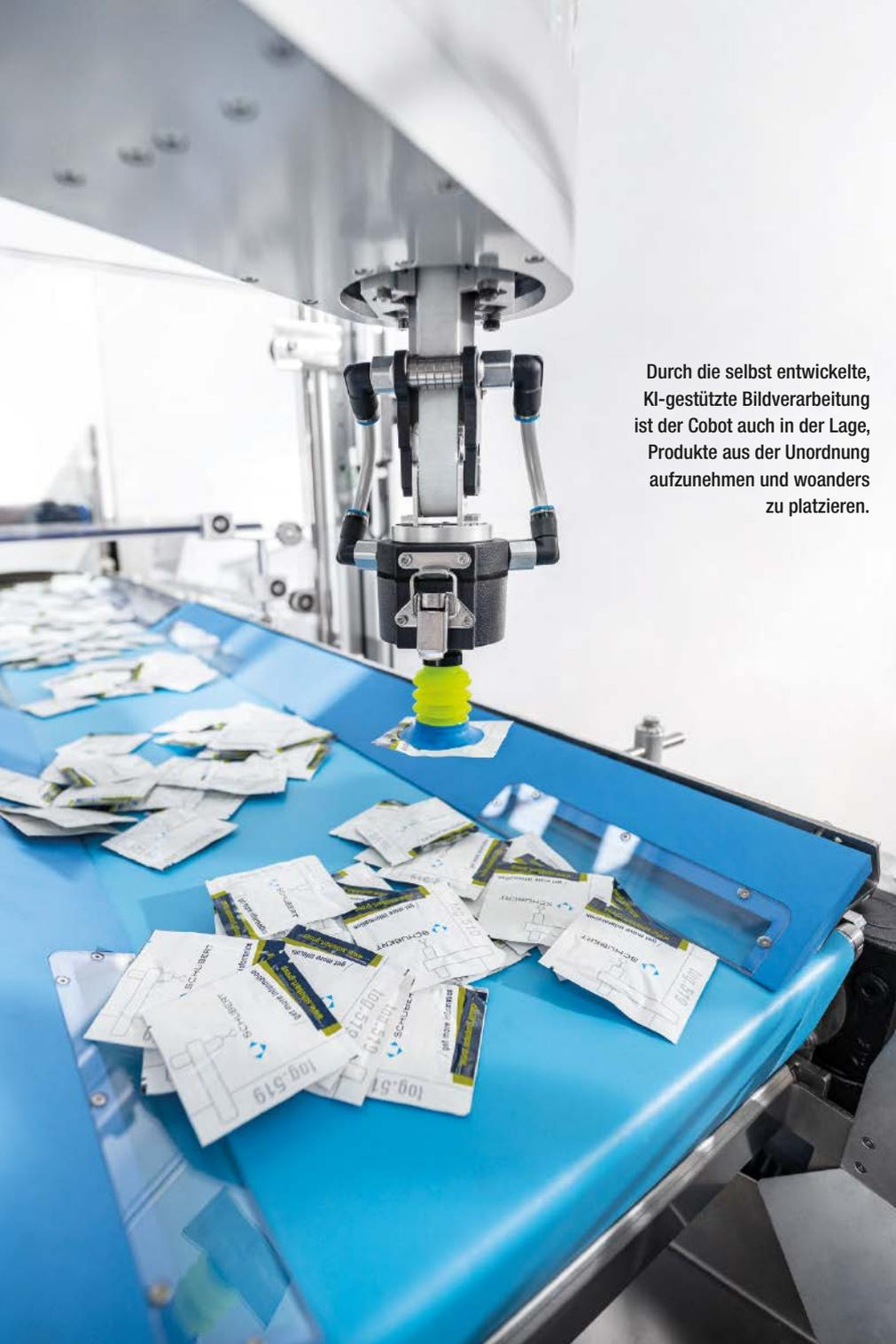
Durch die selbst entwickelte, KI-gestützte Bildverarbeitung ist der Cobot auch in der Lage, Produkte aus der Unordnung aufzunehmen und woanders zu platzieren.
