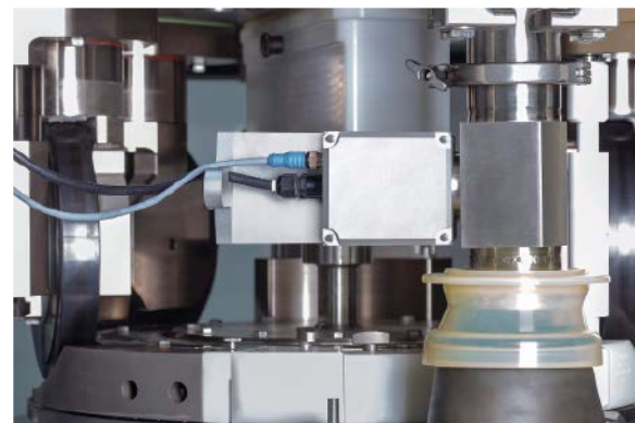
In den Produktionsprozess integrierter Nahinfrarotsensor im Füllrohr einer Rundläufer-tablettenpresse (BU-Messkopf in seitlicher Ansicht).
