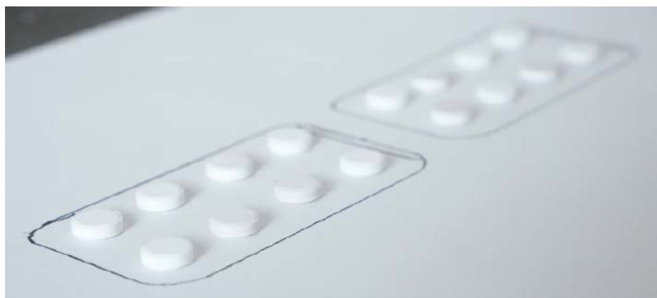
Auf einem Förderband unterhalb der Kamera bewegen sich die Proben unter dem UV-Licht, die mittels Pushbroom-Technologie vom BlueEye erfasst werden.
