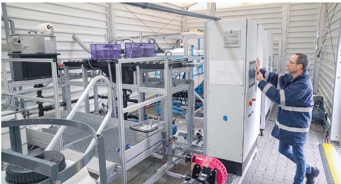
Das ePhos-Verfahren des Fraunhofer IGB fällt Phosphor elektrochemisch als Magnesium-Ammonium-Phosphat – kurz Struvit – und macht ihn so als regionalen Langzeitdünger nutzbar.
