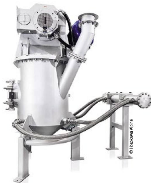
Abb. 2: Die Fließbett-Gegenstrahlmühle TDG mit integriertem Sichter kommt u.a. beim Mahlprozess zur Herstellung von Recovered Carbon Black zum Einsatz
