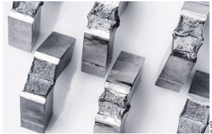
Abb. 4: Der Kerbschlagbiegeversuch dient der Werkstoffprüfung und hilft, die Festigkeit des Materials bezogen auf die spätere Beanspruchung hin zu beurteilen. Dabei wird ein eingekerbter Probenquader durch einen Pendelhammer verformt.
