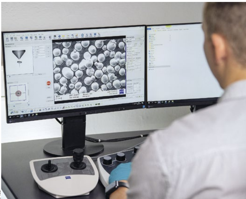
Abb. 2: Statische Bildanalyse von Metallpulver unter dem Rasterelektronenmikroskop (REM). Partikelform, Korngrößen und sonstige Effekte (Anhaftungen, Satelliten etc.) werden dokumentiert.
