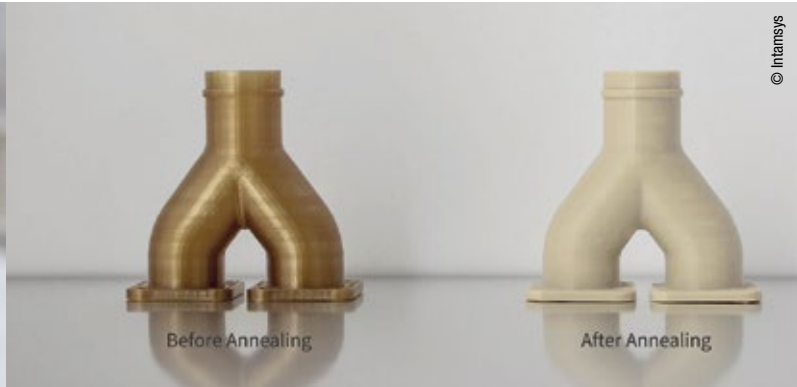
Abb. 2: Verteilerrohr gedruckt aus Victrex AM 200 Filament vor und nach dem Tempern.
