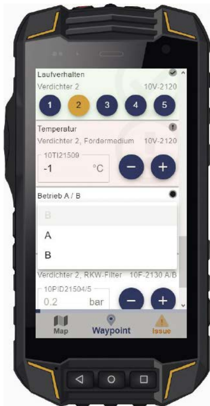
Während des Rundgangs lassen sich die Daten digital erfassen, ein Übertrag handschriftlicher Notizen nach dem Rundgang entfällt.
