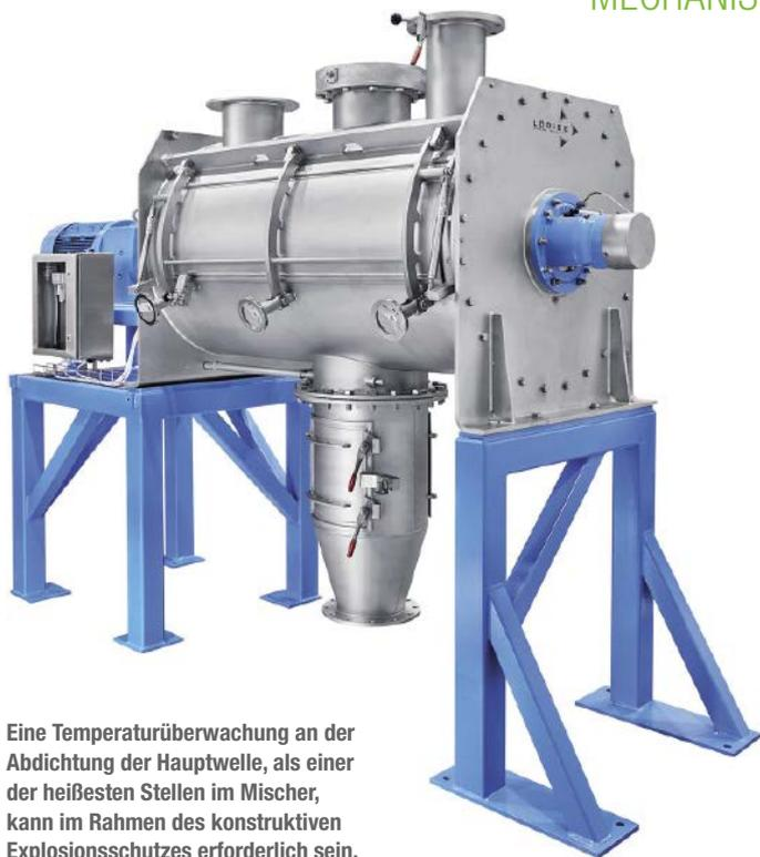
Eine Temperaturüberwachung an der Abdichtung der Hauptwelle, als einer der heißesten Stellen im Mischer, kann im Rahmen des konstruktiven Explosionsschutzes erforderlich sein.
