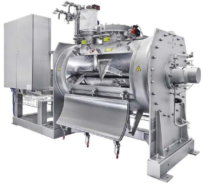
Durch den Wärmeeintrag eines Doppelmantels für Beheizung und Kühlung können am Mischer heiße Oberflächen entstehen. Hierbei ist es wichtig, dass die zugeführte thermische Energie unterhalb der Zündtemperatur liegt.
