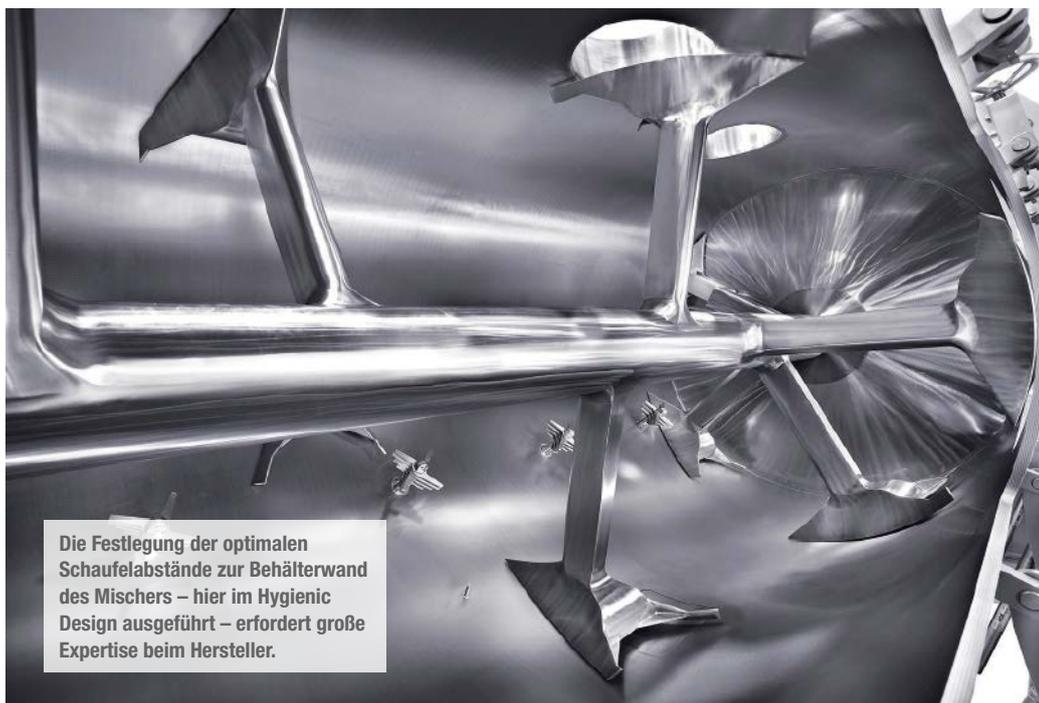
Die Festlegung der optimalen Schaufelabstände zur Behälterwand des Mixers – hier im Hygienic Design ausgeführt – erfordert große Expertise beim Hersteller.
