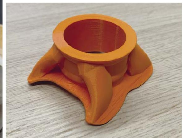
Abb. 1: Additive Fertigung der topologieoptimierten Behälter-Stutzen-Verbindungen bei einem Massenerhalt von 5 % mit Polymer-3D-Drucker (rechts) und WAAM-Verfahren (links)<sup>[4]</sup>
