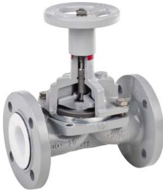
Abb. 2: SISTO Membranventil mit gekammerter und spiralabgestützter TFM-Membrane.
