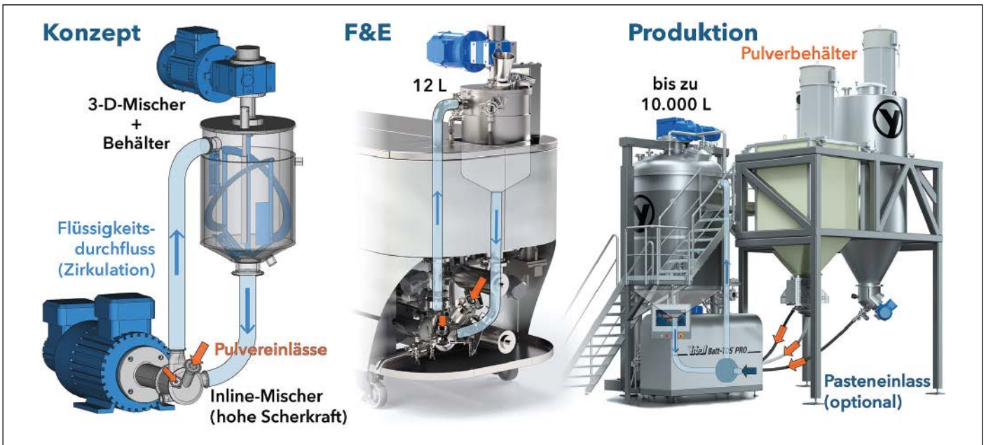
Abb. 2: Batt-TDS-Mischkonzept für Elektroden-Slurry, das sowohl einen Inline-Mischer für Pulvereinzug und -dispersion in einem Flüssigkeitsstrom als auch einen 3D-Mischer mit niedriger Scherrate im Behälter für die Chargenhomogenisierung enthält.
