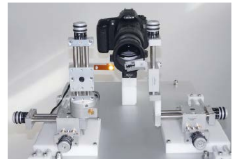
Abb. 2: Feinjustiereinheit sowohl für die LED als auch der Rasierklinge in allen Dimensionen. Rasierklinge und LED sind dann im identischen Abstand zum Spiegel – 2 mal Brennweite des Spiegels.
