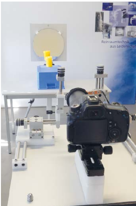
Abb. 3: Darstellung des Gesamtaufbaus aus Blickrichtung der Kamera hin zum Spiegel. Die Kamera ist auf dem horizontalen Schlitten verfahrbar.
