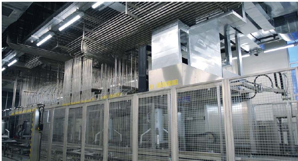
Flüssigkeiten und Pulver werden exakt dosiert mit automatisierten Dosier- und Abfüllanlagen für die Parfum- und Aromenindustrie.
