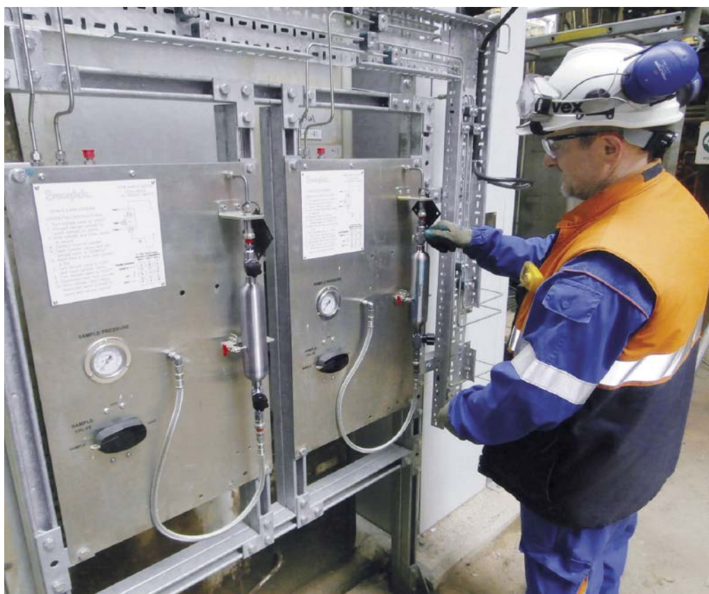
Bei der Stichprobenahme stellen Bediener sicher, dass Flüssigkeiten oder Gase in einem geeigneten Behälter aufgefangen und anschließend an ein Labor geschickt werden, um die Prozessbedingungen zu überprüfen und die Produktqualität sicherzustellen.
