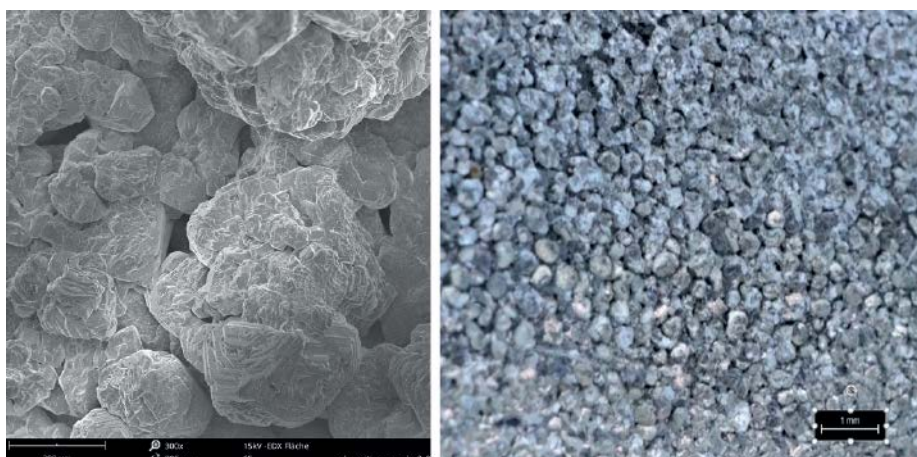
Abb. 2: Die Aufnahme einer geladenen Zinkelektrode mit 270 mAh/cm 2 mit Rasterelektronenmikroskop (links) und Makroskop (rechts) zeigt Schichten mit einer grobkörnigen Oberfläche, die aber eine hohe Dichte aufweisen und mechanisch stabil sind. Es entstehen keine Dendriten, die sonst zu Kurzschlüssen führen würden.
