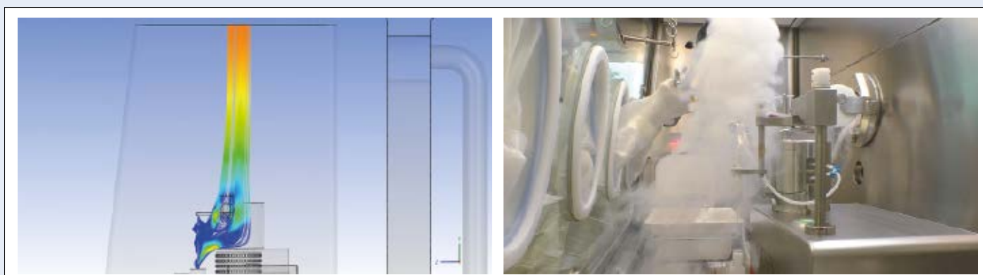
Abb. 2 a+b: Umströmung einer Füllnadel durch Erstluft in einem Isolator. Das linke Bild zeigt den Nachweis im Rahmen einer CFD Simulation (Design) und das rechte Bild den Nachweis bei der Strömungsvisualisierung an der realen Anlage im Rahmen der Qualifizierung
