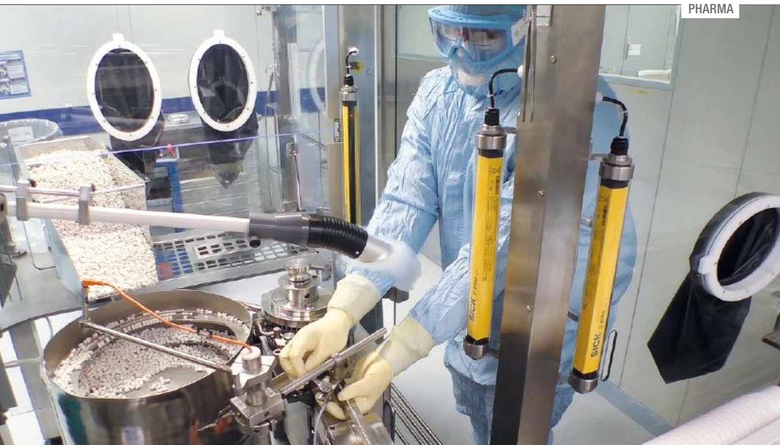
Abb. 1: Visualisierung einer Personaleingriffs mit offener Tür an einem RABS. Nebelaufgabe an der Kleidung des Operators.
