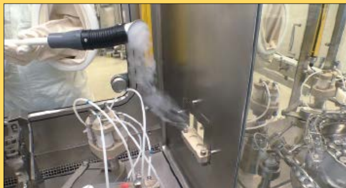
Abb. 6: Visualisierung der Überströmung am Mousehole eines offenen Isolators. Zusätzlich ist im weiteren Verlauf der Strömungsvisualisierung abströmseitig vom Mousehole Nebel aufzugeben und zu prüfen, ob Nebel in den Isolator eindringt.
