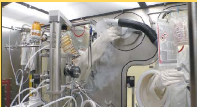
Abb. 5: Handschuhengriff an einem RTP (Rapid Transfer Port) eines Isolators mit Strömungsvisualisierung und Nebelaufgabe oberhalb des Handschuhs. Zusätzlich wird im weiteren Verlauf Nebel unterhalb des Handschuhs aufgegeben.
