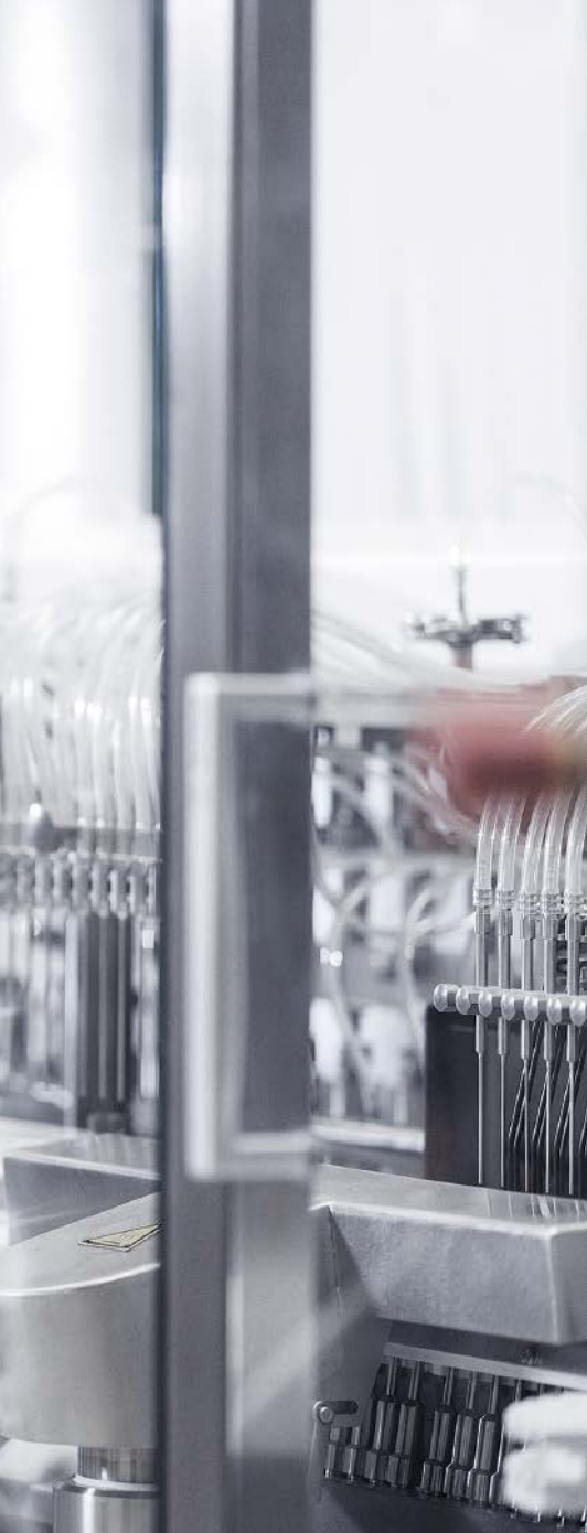
Abb. 1: Ein Grundgedanke des neuen Annex 1 ist die Trennung des aseptischen Prozessraumes von der Bedienumgebung. Hierfür empfiehlt das Dokument zum ersten Mal eindeutig den Einsatz von entsprechenden Barriere-Technologien.
