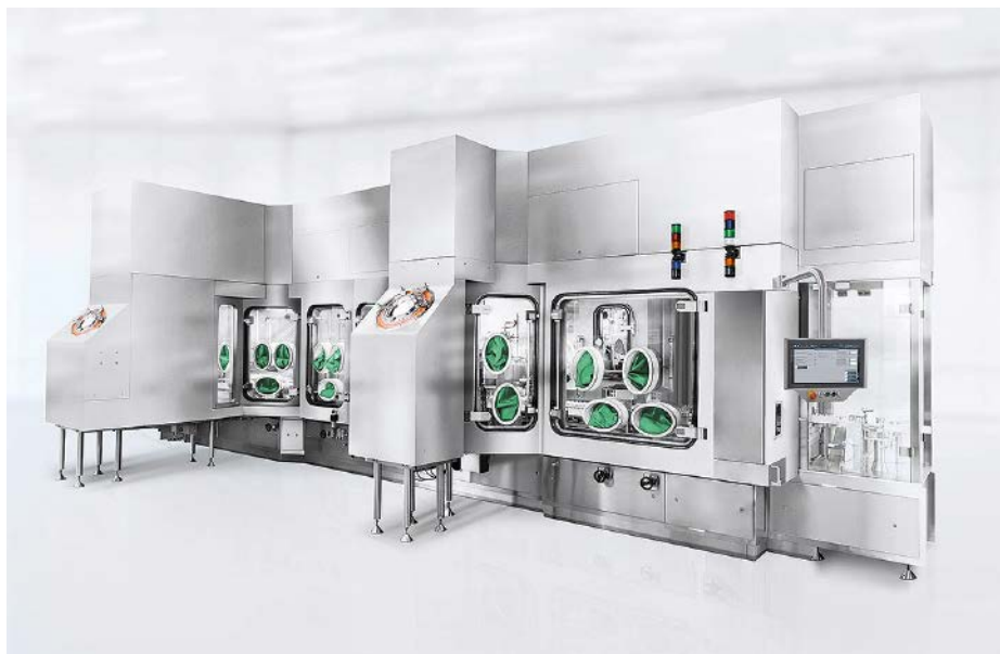
Abb. 1: Ein Grundgedanke des neuen Annex 1 ist die Trennung des aseptischen Prozessraumes von der Bedienumgebung. Hierfür empfiehlt das Dokument zum ersten Mal eindeutig den Einsatz von entsprechenden Barriere-Technologien.
