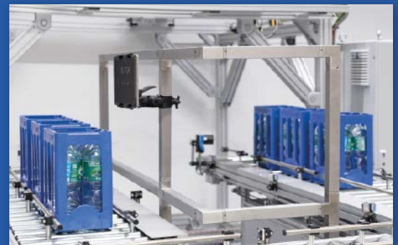
Abb. 3: Jedes EMS-Element besteht inklusive Spannverbinder aus Edelstahlguss
